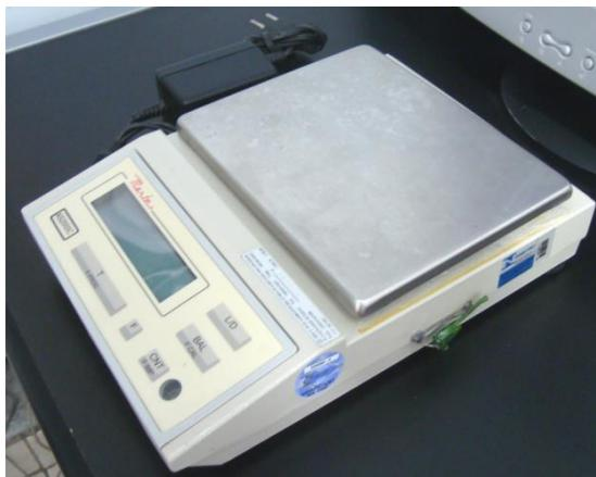
**Figura 9-** Balança de precisão.
