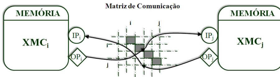
**Figura 2.12:** Comunicação dos componentes X-Machine  $XMC_i$  e  $XMC_j$  através das portas  $OP$  e  $IP$  (adaptado de Kefalas, Eleftherakis e Kehris (2003b)).
