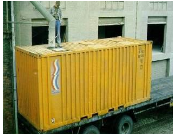
Figura 5: Contêiner de 20' desenvolvido para transportar grãos na década de 1980.
