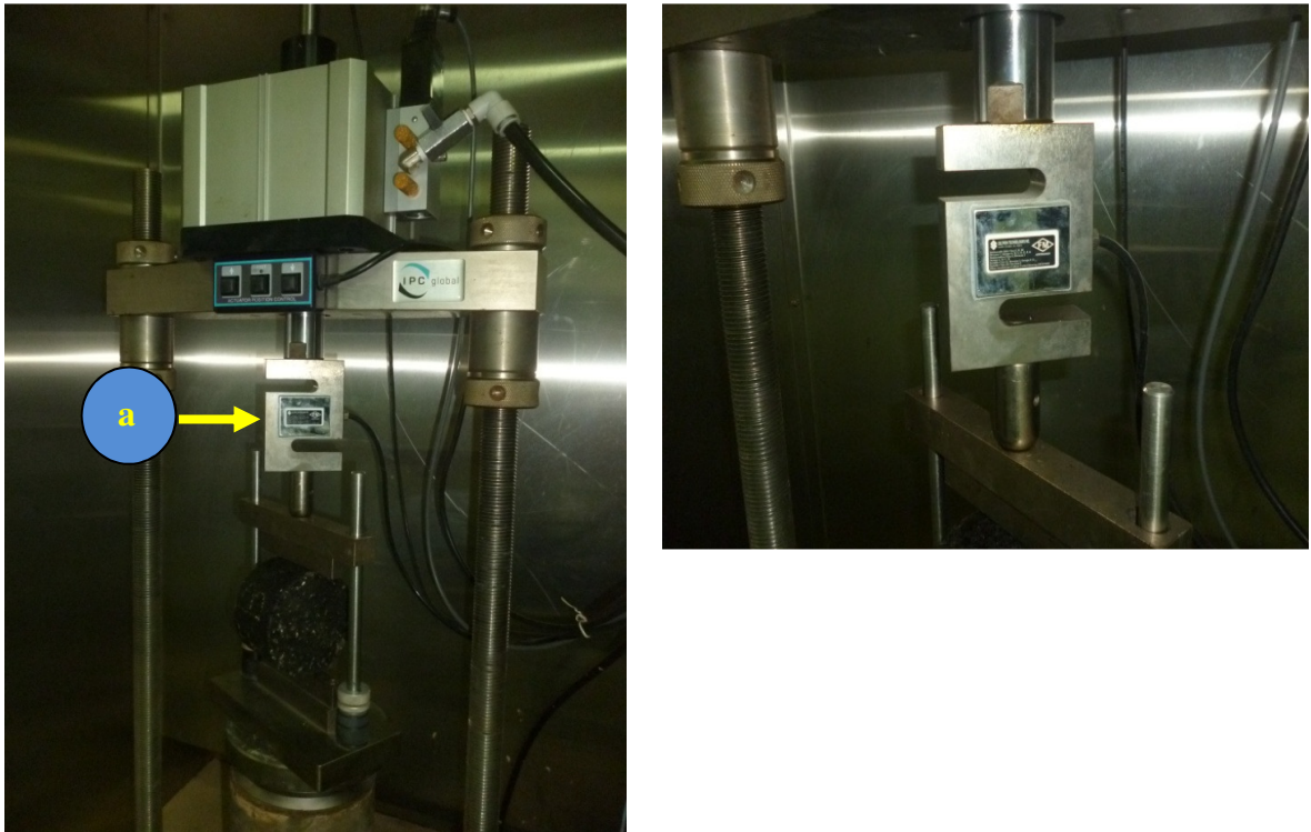
Figura 6 – Prensa UTM e detalhe da célula de carga
