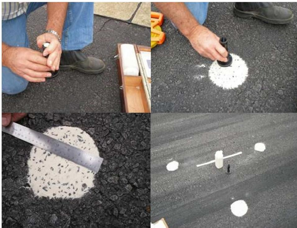
Figura 35– Sequencia do ensaio da Mancha de Areia
