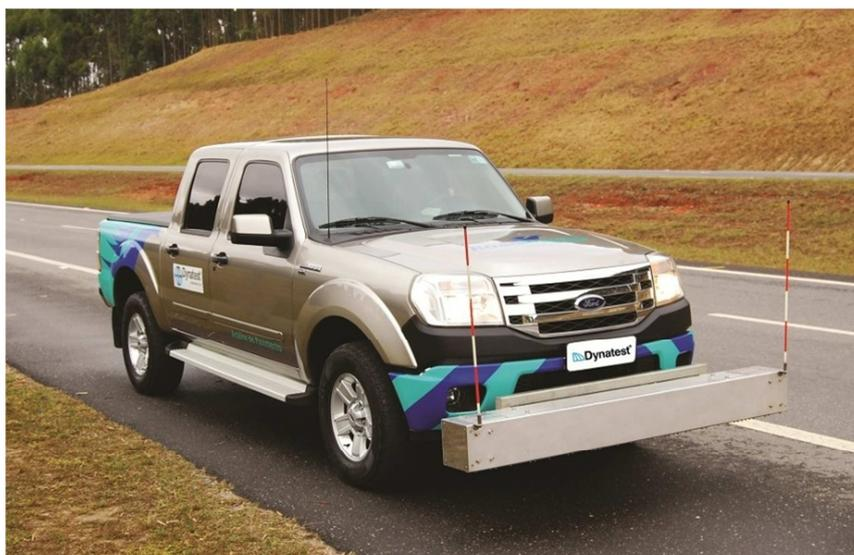
Figura 21 – Perfilômetro a laser.
