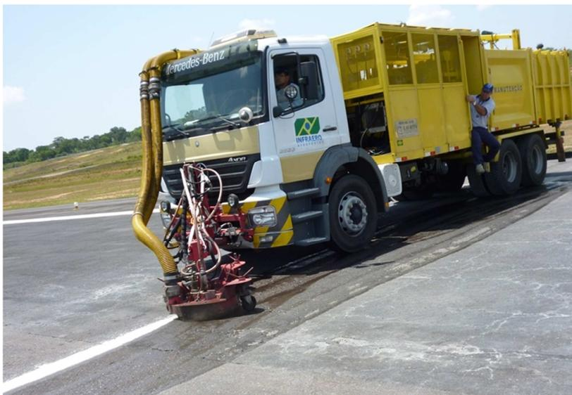
Figura 37– Equipamento removedor de borracha
