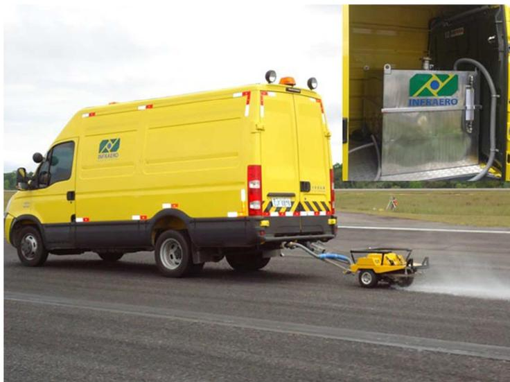
Figura 33 – Conjunto medidor de atrito (detalhe do reservatório no canto direito superior)
