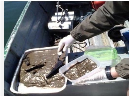
Figura 19 – Ilustração do procedimento de coleta e armazenamento da amostragem de sedimento.
