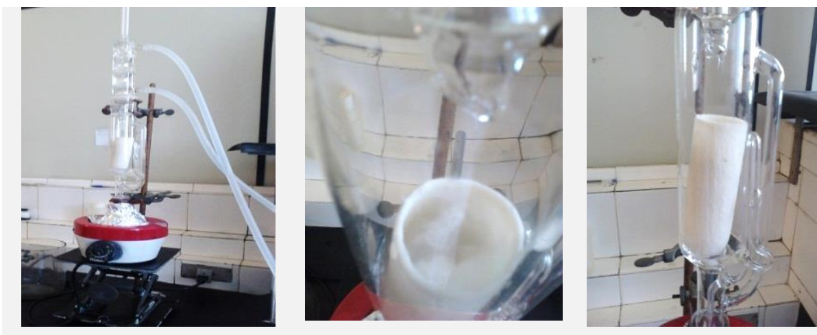
Figura 27 – Ativação do algodão em diclorometano por Soxhlet.
