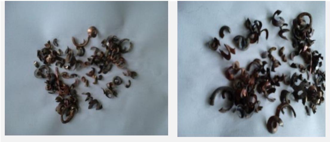
Figura 22 – Cobre retirado das amostras após extração.
