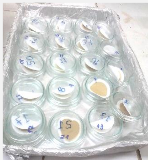
Figura 17 – Amostragem, sistema de filtração a vácuo e pesagem de sólidos em suspensão.
