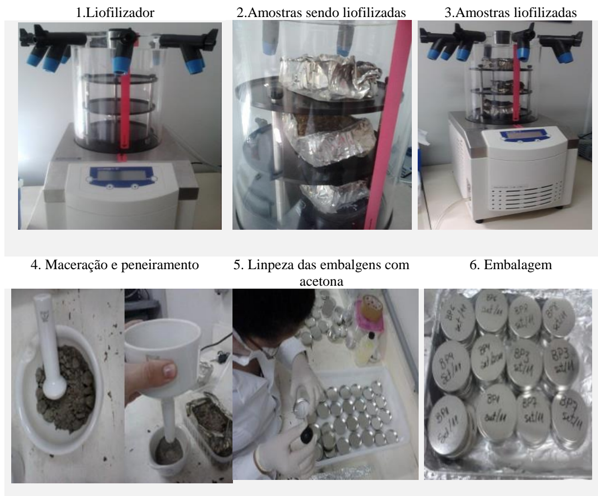
Figura 20 – Tratamento das amostras para análise de hidrocarbonetos.
