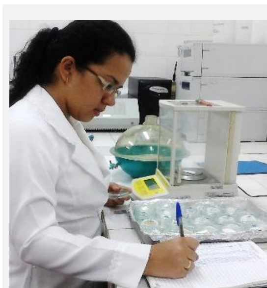
Figura 17 – Amostragem, sistema de filtração a vácuo e pesagem de sólidos em suspensão.
