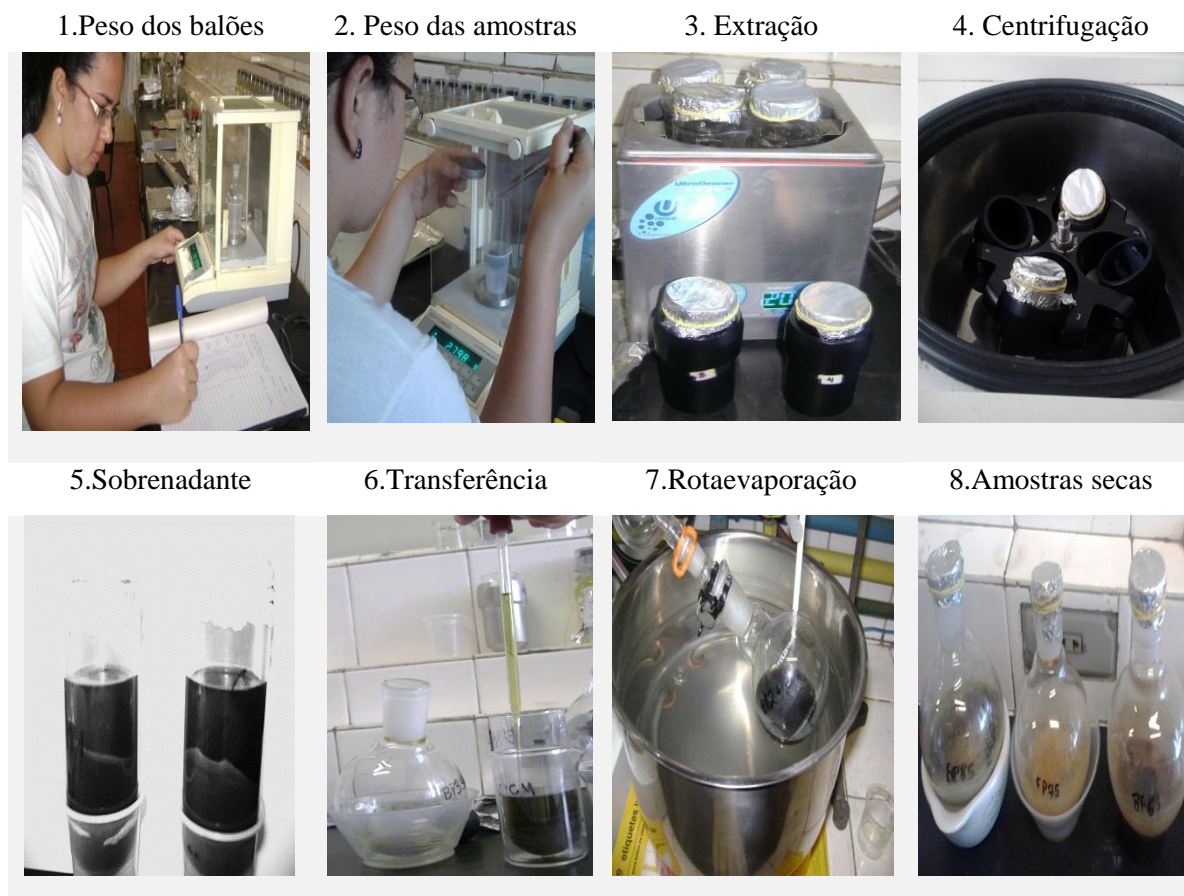
Figura 24 – Processo de extração das amostras
