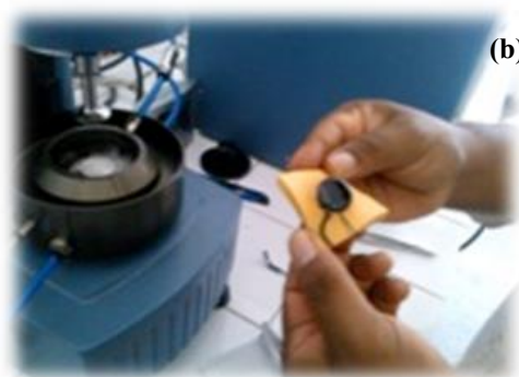
Figura 39. (a) - Reômetro de Cisalhamento Dinâmico do Laboratório Desenvolvimento e Caracterização de Materiais da Faculdade de Engenharia Química da Universidade Federal de Sergipe (UFS). (b) – Detalhe da amostra sendo retirada do molde para inserção no reômetro.
