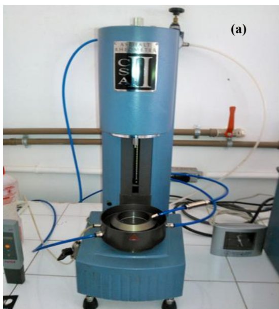
Figura 39. (a) - Reômetro de Cisalhamento Dinâmico do Laboratório Desenvolvimento e Caracterização de Materiais da Faculdade de Engenharia Química da Universidade Federal de Sergipe (UFS). (b) – Detalhe da amostra sendo retirada do molde para inserção no reômetro.
