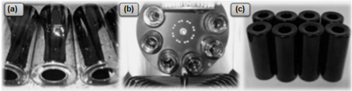
Figura 33 - Ensaio de durabilidade em estufa. (a) Detalhe dos frascos com amostras. (b) Frascos de vidro com amostras fixados no tambor rotativo do equipamento RTFOT. (c) Frascos com amostras após o ensaio. Fonte: SOUZA, 2010.
