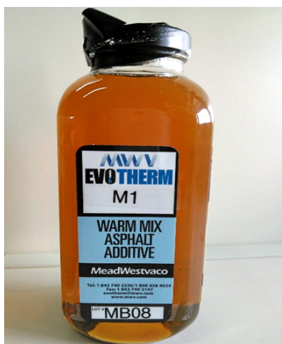
Figura 30 - Exemplo da amostra de Evotherm M1 fornecido pelo representante da empresa MWV, no Brasil.
