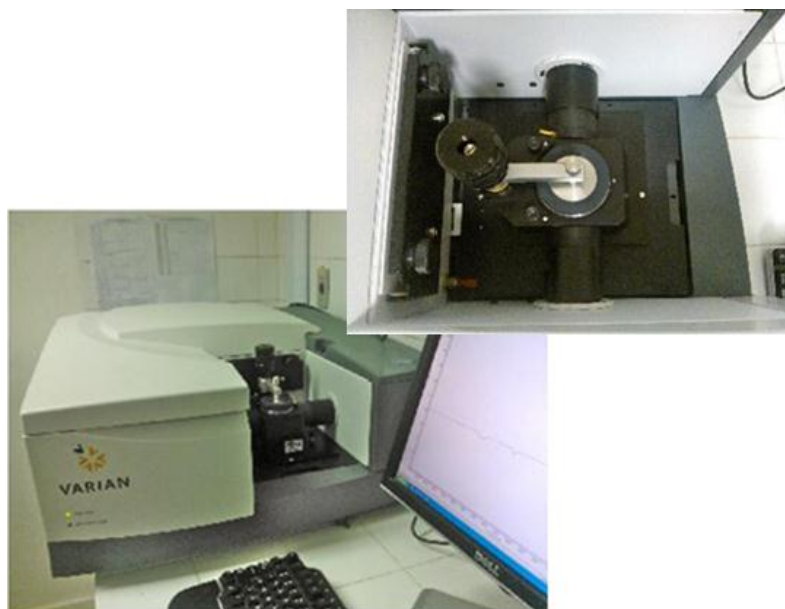
Figura 42 - Espectrômetro de FTIR, com detalhe da câmara de amostra, do Laboratório de Desenvolvimento e Caracterização de Materiais da Faculdade de Engenharia Química da Universidade Federal de Sergipe (UFS).
