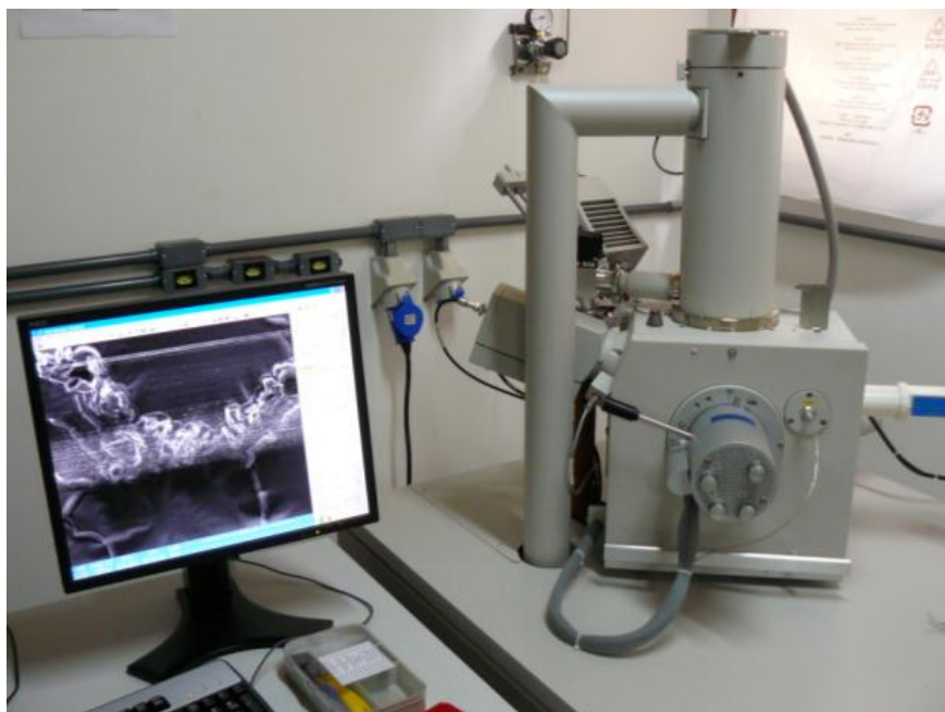
Figura 34. Microscópio eletrônico de varredura marca FEI, modelo QUANTA 250, com detalhe da imagem reproduzida no monitor do computador, do Laboratório de Técnicas Mineralógicas do Departamento de Geociências da Universidade Federal do Amazonas.
