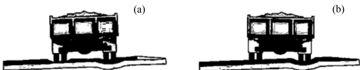
Figura 20 - Deformação permanente em pavimentos flexíveis. Fonte: BERNUCCI et al. , 2006.
