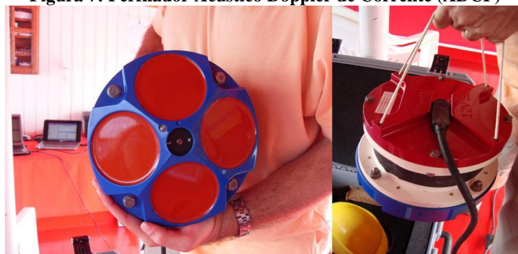
Figura 7: Perfilador Acústico Doppler de Corrente (ADCP)
