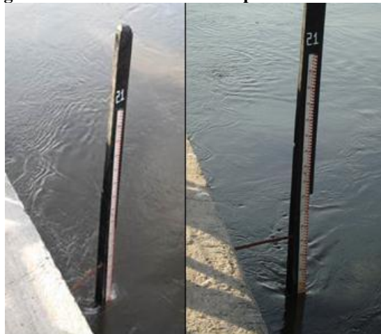
Figura 6: Instrumento utilizado para medir Cota (H)
