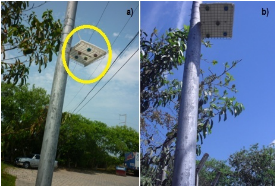
Figura 27. Ponto (11): Fixação dos amostradores passivos (27a); Visão ao redor do ponto de amostragem (27b);
