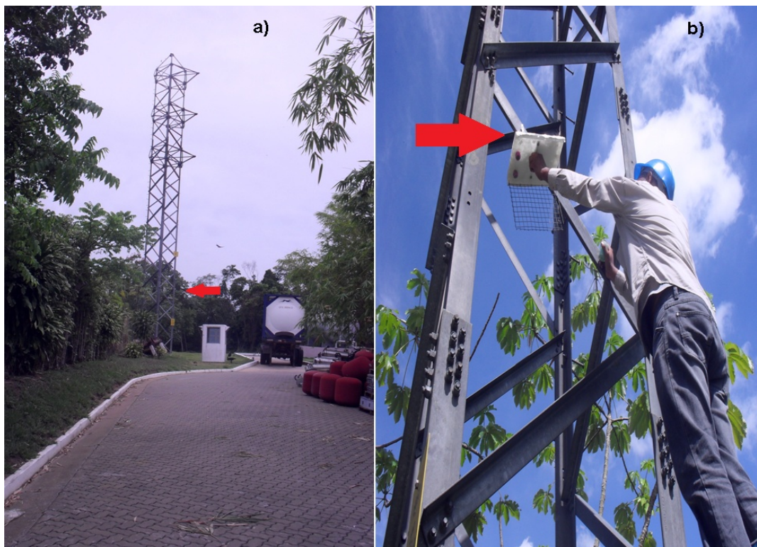
Figura 21. Ponto (4): Visão ao redor do local de amostragem (21a); Colocação dos amostradores passivos (21b). Fonte: Márcia Passos da Costa, 2012.
