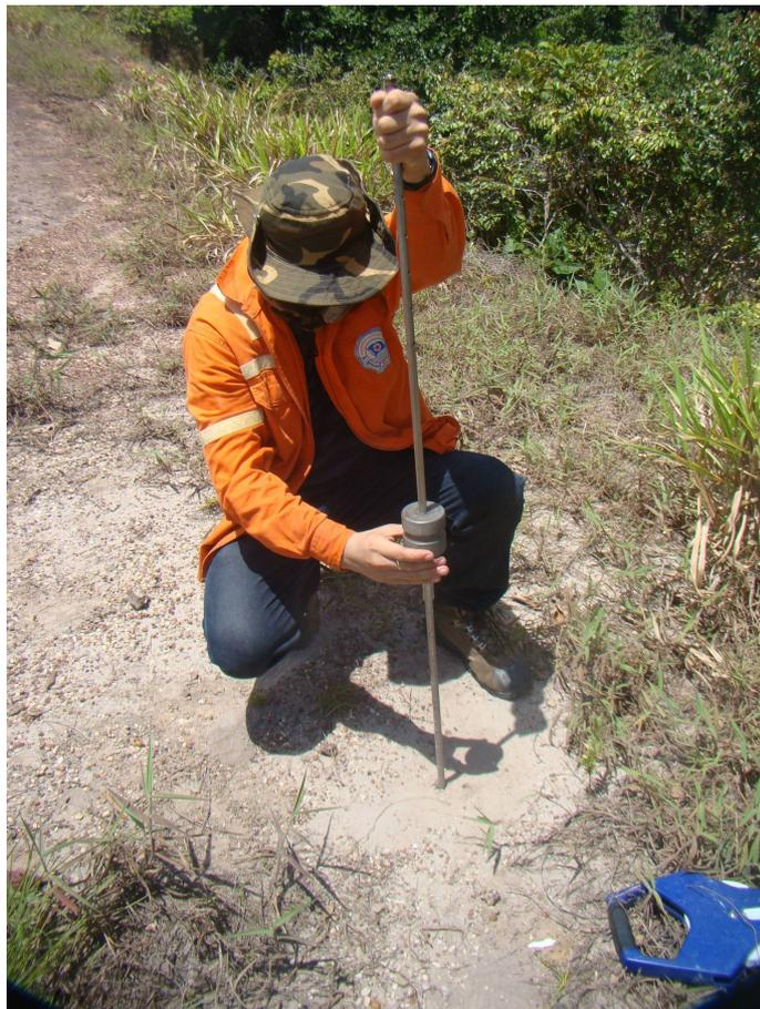
Figura 19: Realização do teste do penetrômetro no km 116, na rodovia AM-010.
