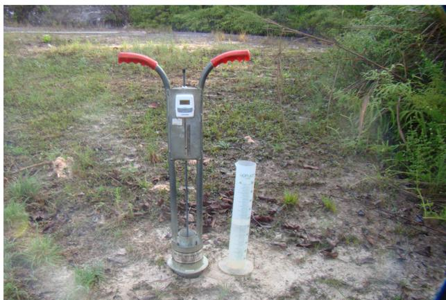
Figura 20: Infiltrômetro utilizado nos testes para absorção de água no solo.
