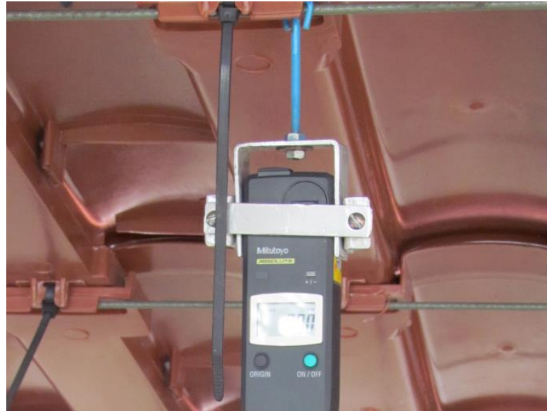
Figura 75 - Mecanismo de fixação do relógio comparador à barra metálica.
