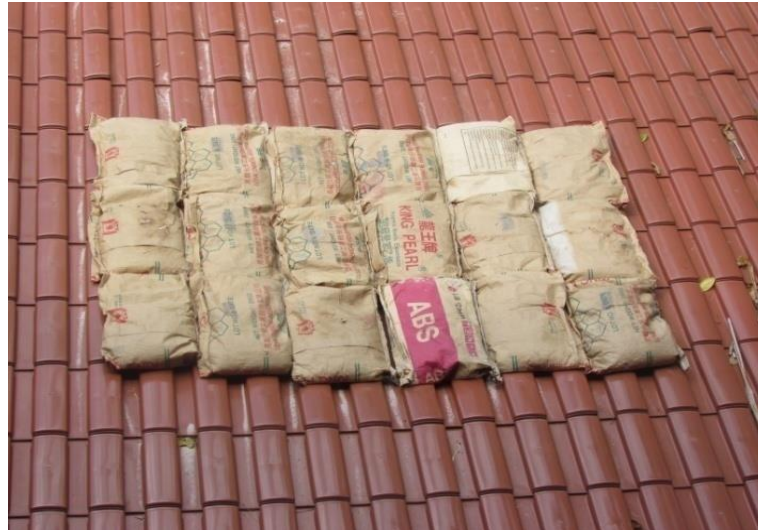
Figura 79 - Carregamento distribuído sobre a superfície da cobertura.
