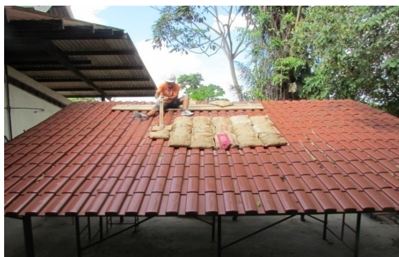
Figura 78 - Colocação de sacos de areia de 10 kg representando a carga externa.
