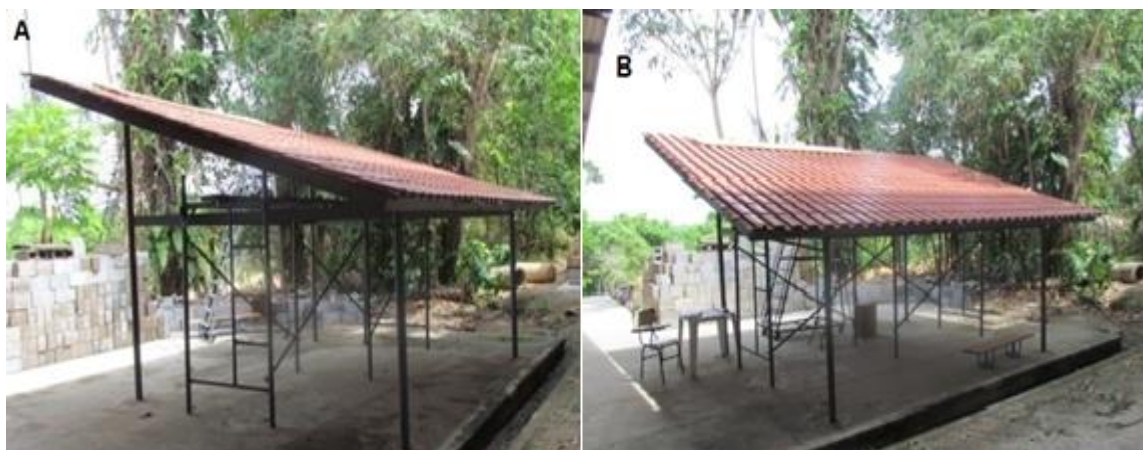
Figura 58- Modelo experimental com suporte central: A) vista de frente; B) vista lateral.
