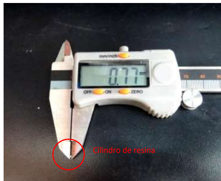
Figura 33 - Aferição do diâmetro do cilindro de resina obtido através do tubo de silicone.
