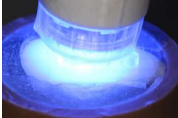
Figura 28 - Fotopolimerização do compósito por 40 segundos.
