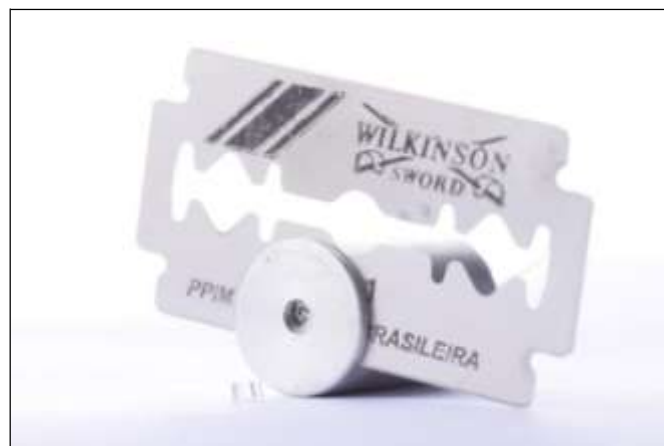
Figura 23 - Lâmina utilizada para seccionar o tubo de silicone.
