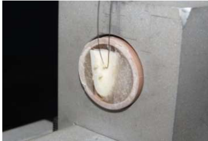
Figura 32 - Fio de aço 0,2 mm cisalhando os cilindros de resina.
