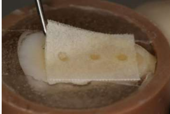
Figura 21 - Fita dupla-face perfurada a fim de delimitar a área de adesão.
