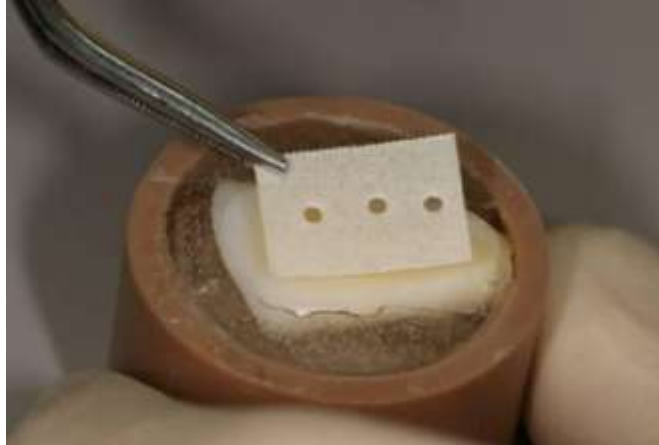
Figura 6 - Fita dupla-face perfurada a fim de delimitar a área de adesão.
