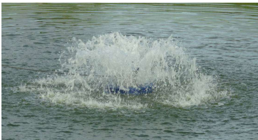
Figura 7. Aerador de aspersão vertical.
