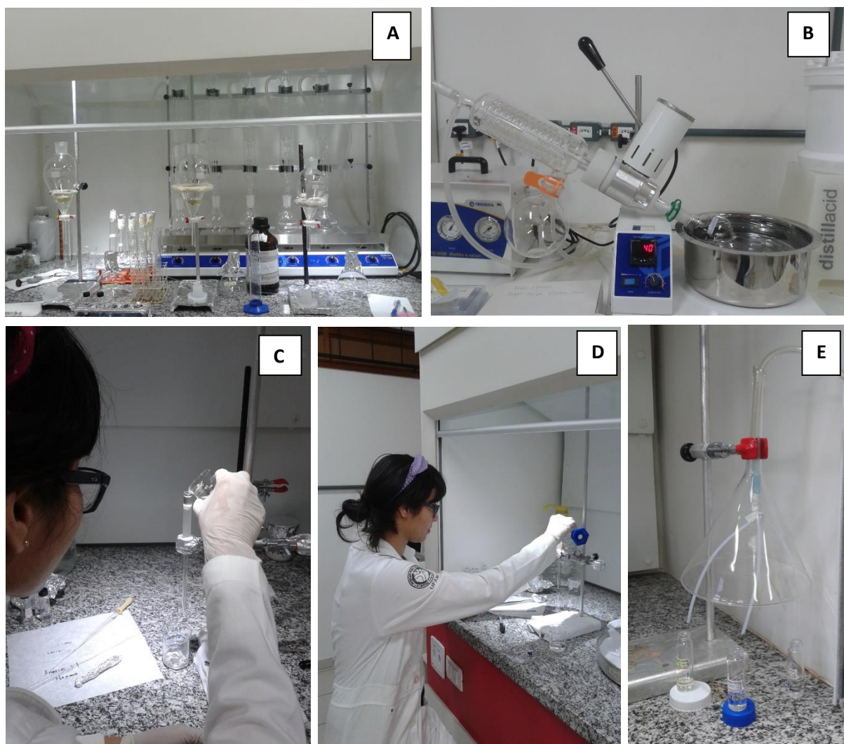
Figura – (A) Extração líquido-líquido das amostras; (B) Concentração dos extratos em evaporador rotativo; (C) Fracionamento em coluna aberta de vidro; (D) Eluição dos extratos e obtenção das frações; (E) Secagem das amostras em fluxo de nitrogênio.
