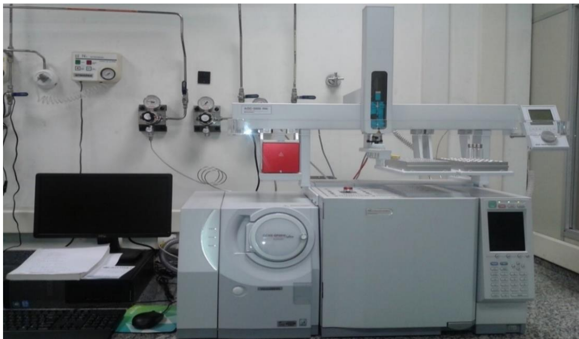
Figura 12 - Cromatógrafo gasoso acoplado à espectrometria de massas (CG-EM) – Central de Laboratórios – FUCAPI, Manaus-AM, 2015.
