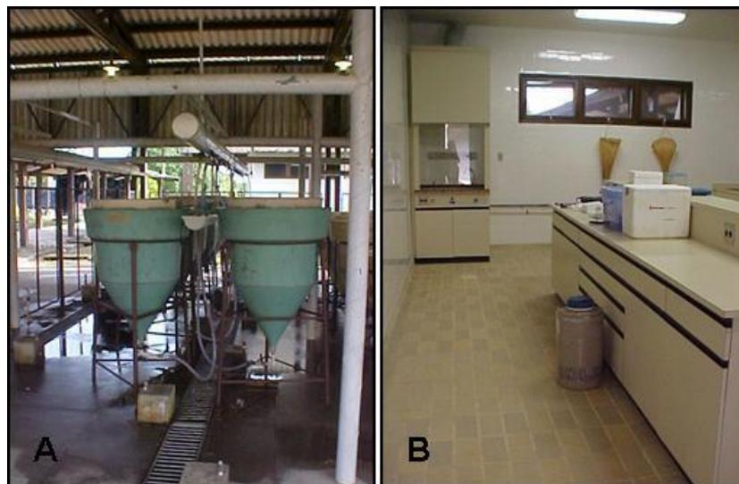
**Figura 2.** Incubadoras cônicas de 120 L, com sistema de circulação de água (A). Laboratório de apoio do Centro de Tecnologia, Treinamento e Produção em Aquicultura – CTTA (B).
