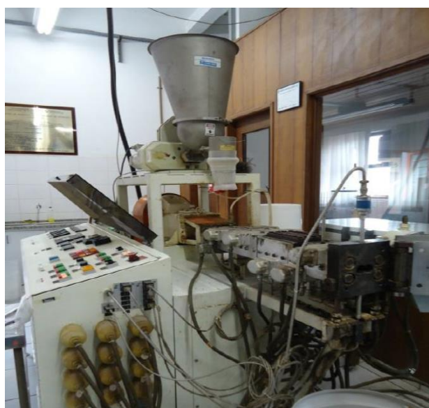
Figura 8: Extrusor dupla-rosca Brabender (modelo 20 D/N-GNF 1014/2), Santos (2014).
