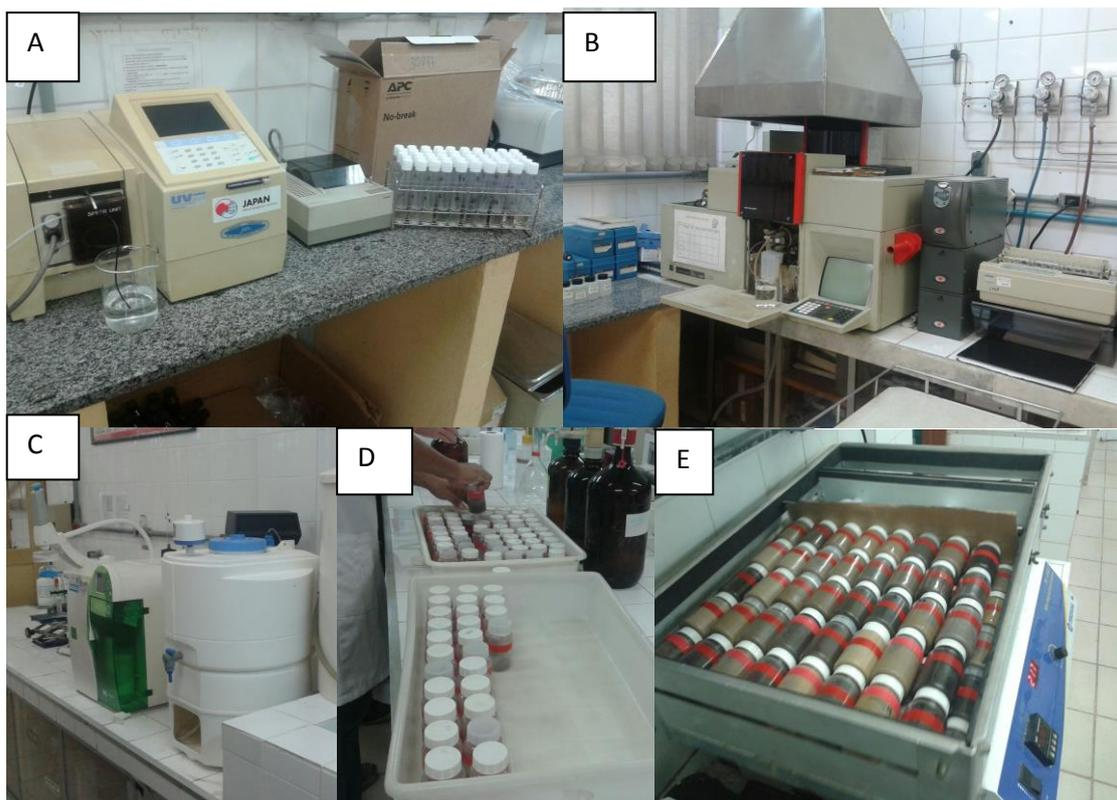
**Figura 13:** Mosaico dos procedimentos para análise química. Em A, aparelho leitor de macronutrientes; em B, aparelho leitor de micronutrientes; em C, material de água destilada e aparelho leitor de pH; em D, procedimento para obtenção dos macronutrientes; em E, as amostras estão sendo agitadas.
