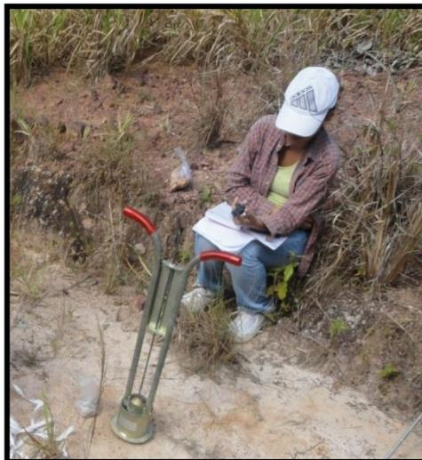
**Figura 14:** Teste de infiltrômetro.
