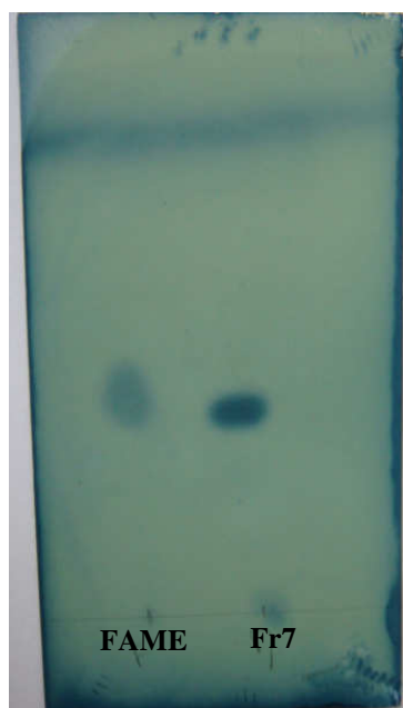
Figura 60. Análise por CCDC-FN da fração Fr7 isolada da coluna sílica FLASH. Placa eluída em hexano:acetato de etila (95:5). Revelada em solução etanólica de ácido fosfomolibdico 20 %.
