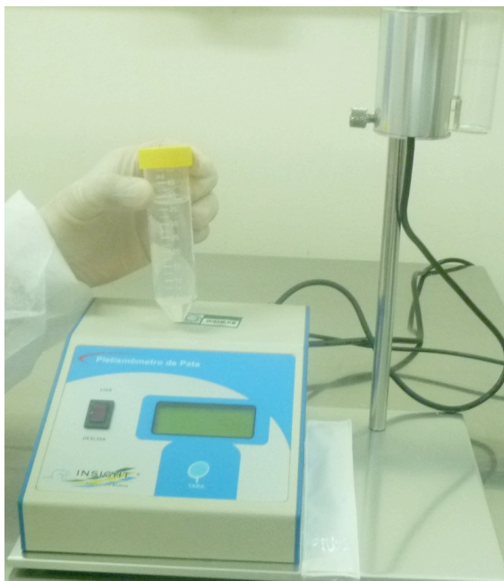
Figura 9 - Pletismômetro Insight ® modelo EFF-304. Equipamento utilizado para obtenção do volume das patas traseiras dos ratos.
