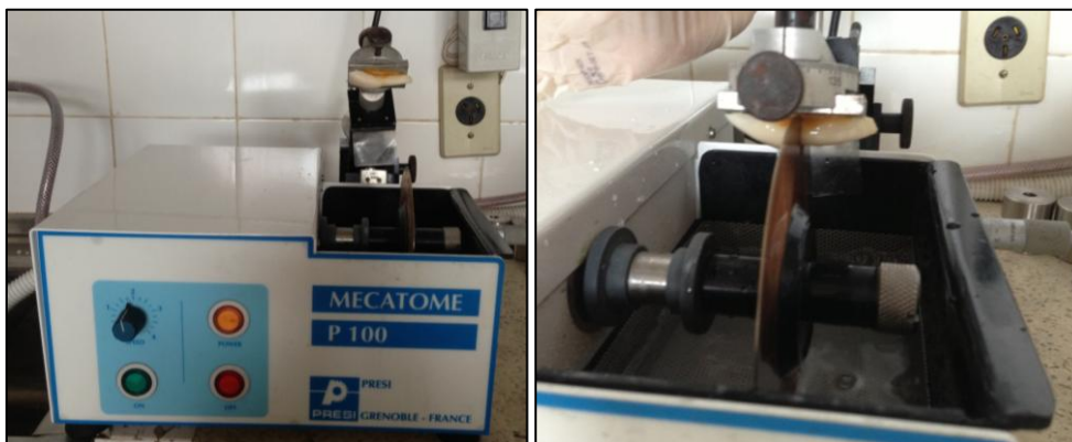
Figuras 21 e 22: Dente bovino posicionado na cortadeira (PRESI Mecatome, Grenoble-France, p100, 1992, para o seccionamento dentário
