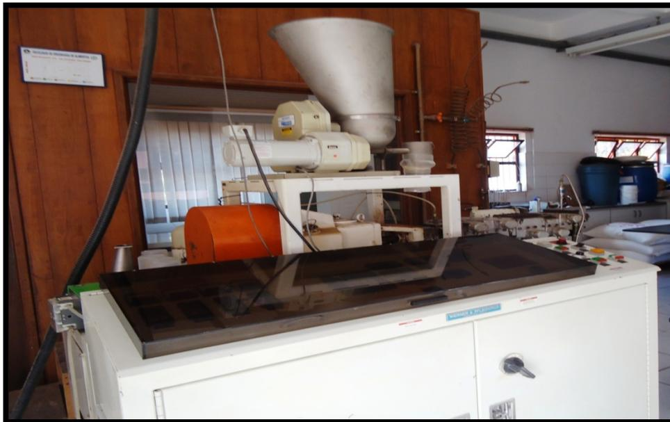
**Figura 4: Extrusora dupla rosca para elaboração de extrusados da UNICAMP-SP**
