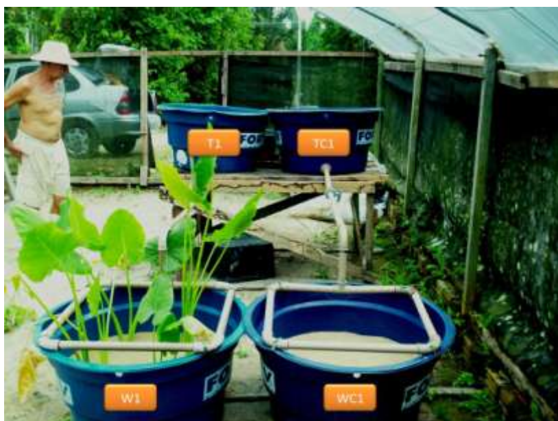
Sistema wetland (W1) composto por filtro (T1) e sistema controle TC1 e WC1
