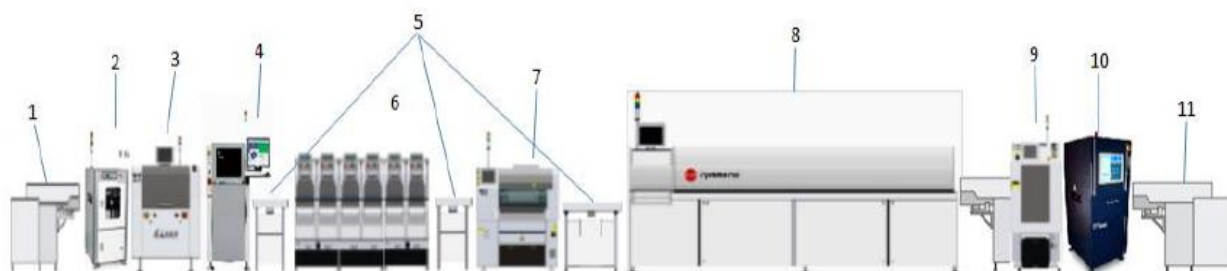
Figura 17. Configuração da linha SMT
