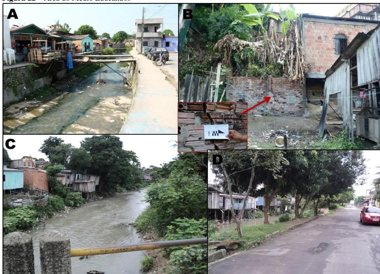
**Nota:** A – Ponte de acesso às residências, em sua maioria de alvenaria; B – Muro construído para conter a erosão da encosta, medida mitigadora do morador, muito embora esteja *embarrigando* e apresentando *rachaduras* (ver detalhe), ademais, há vegetação de bananeiras atrás do muro, que potencializa deslizamentos devido às suas propriedades de armazenamento hídrico; C – Presença parcial de vegetação, mesmo em alguns trechos inadequadas ao longo da BHE.
