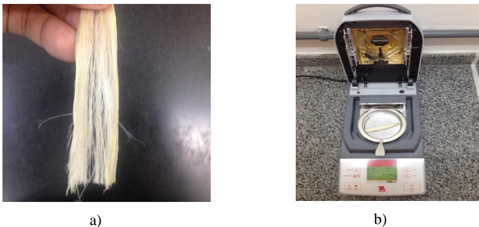
Figura 9 – Tratamento das fibras. (a) Amostras para tratamento com diluições em verniz (b) Medidor de umidade Ohaus.
