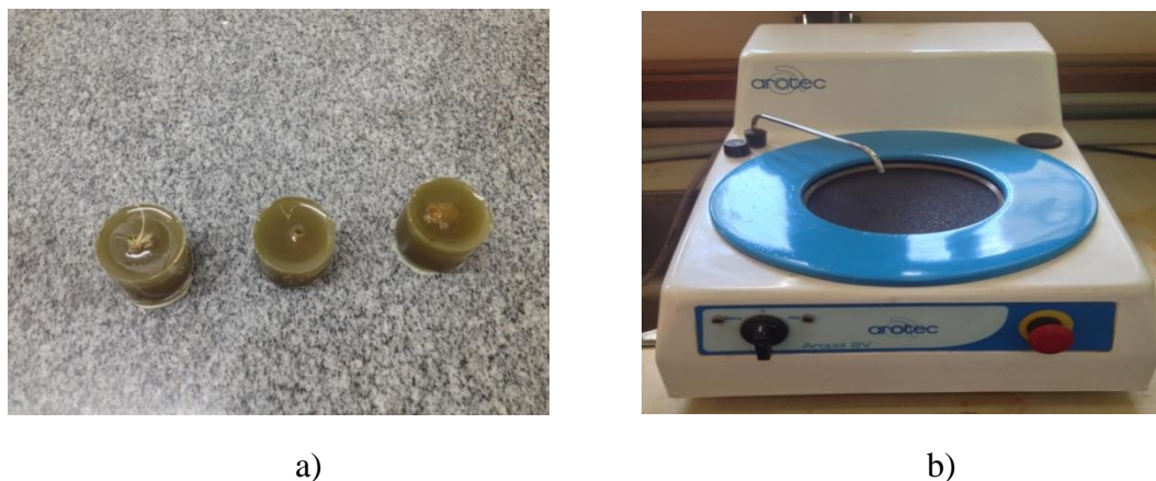
a) amostras após desmolde; b) lixadeira politriz utilizada para o desbaste das amostras.
