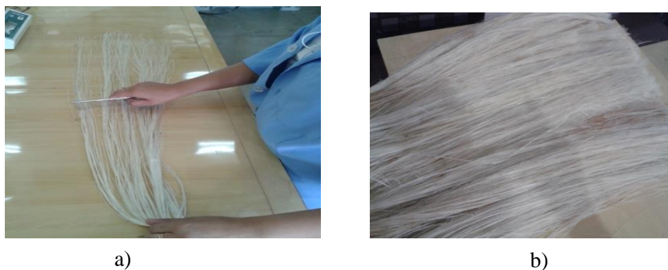
Figura 7 - Preparação das fibras de malva. (a) Penteamento das fibras. (b) Fibras totalmente desembaraçadas e alisadas.
