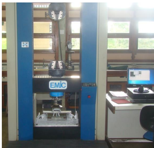
Figura 20 – Equipamento eletromecânico utilizado nos ensaios de tração direta e flexão em 4 pontos.
