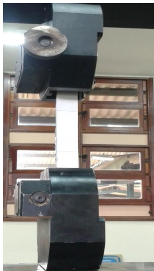
Figura 21 – Amostra presa nas garras metálicas para o ensaio de tração direta.
