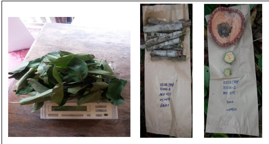
Figura 7 - Amostra de folha, galho e disco de cada compartimento para a determinação do teor de água da madeira. Itacoatiara - AM, 2014.
