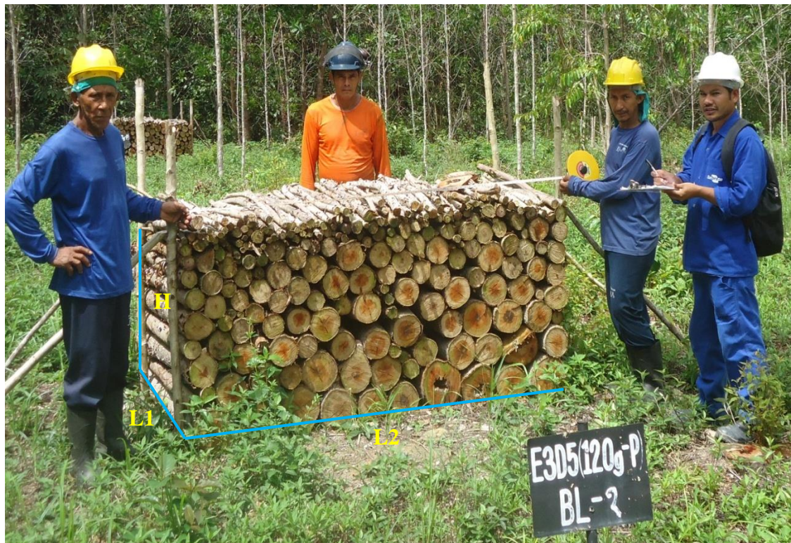
Figura 8 - Mensuração da pilha de madeira para o cálculo do fator de empilhamento. Itacoatiara - AM, 2014.
