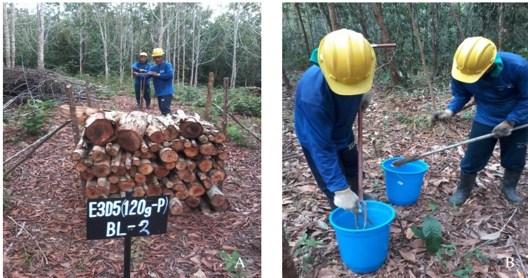
Figura 11 - Coleta de uma amostra composta de solo em cada parcela (Figura 11A), na profundidade de 0 - 20 e 20 - 40 cm (Figura 11B) para análise química e física. Itacoatiara - AM, 2014.
