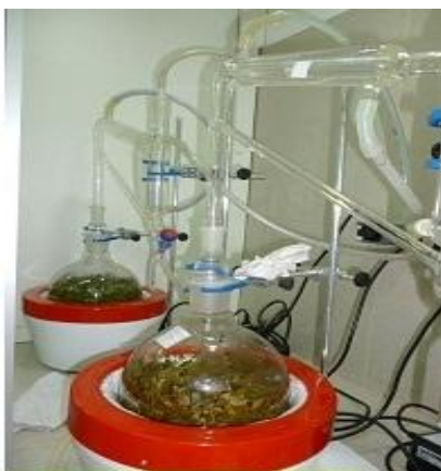
Figura 13. Sistema de hidrodestilação utilizado na obtenção dos óleos essenciais.
