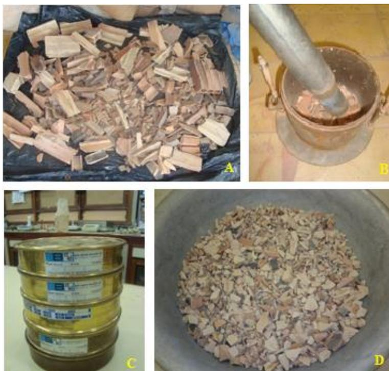
**Figura 31.** Tratamento preliminar do resíduo cerâmico: A) secagem ao ar livre das peças coletadas; B) quebra das peças coletadas no cilindro de Proctor; C) peneiras utilizadas para colocar o resíduo na faixa granulométrica pré-determinada e D) resíduo cerâmico na faixa granulométrica pré-determinada.
