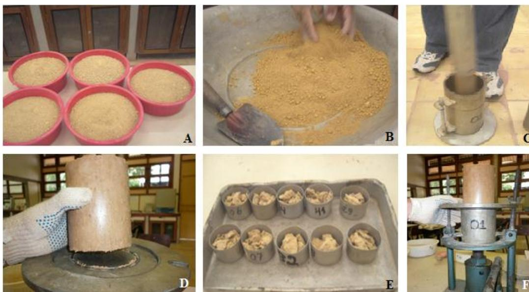
**Figura 17.** Ensaio de Compactação: A) amostras para determinação de pontos de compactação. B) homogeneização das amostras. C) compactação com soquete. D) cilindro de solo compactado. E) amostras de solo compactado para determinação de umidade e posteriormente peso específico. F) extração do cilindro de solo compactado.
