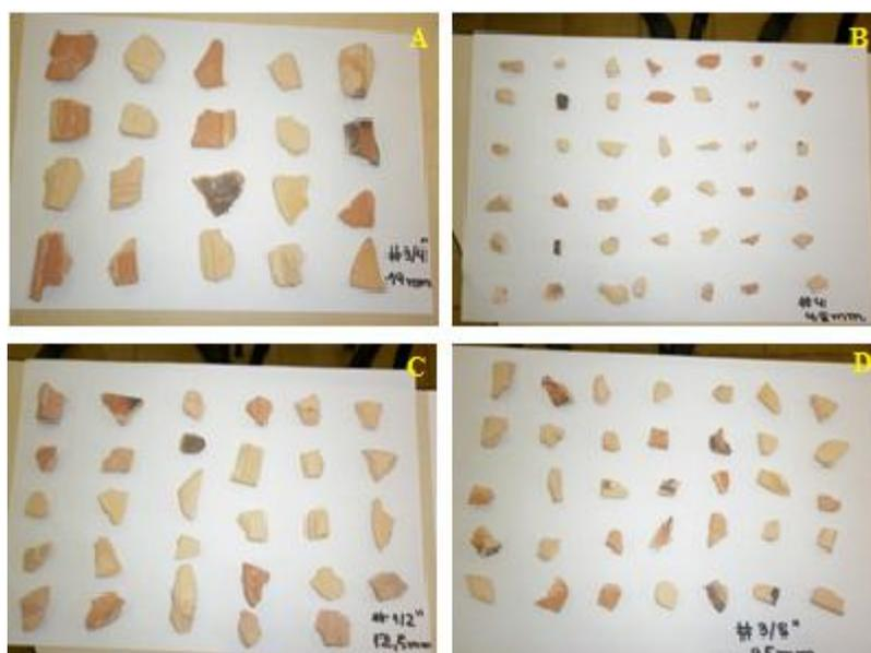
**Figura 32.** Faixa granulométrica do resíduo cerâmico; A) material retido na peneira #3/4" ou 19 mm; B) material retido na peneira #4 ou 4,8 mm; C) material retido na peneira #1/2" ou 12,5mm e D) material retido na peneira #3/8" ou 9,5 mm.
