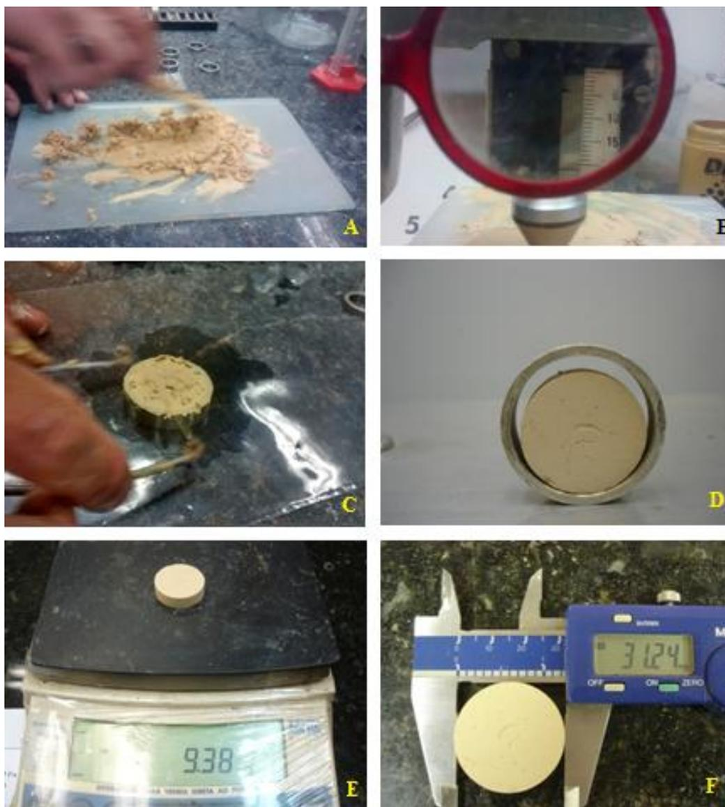
**Figura 19.** Método das pastilhas. A) Espatulação do solo por 8 minutos; B) Penetração do cone por 5 mm; C) Moldagem das pastilhas; D) Pastilhas retiradas da estufa, onde são colocadas em posição vertical. E) Pesagem das pastilhas após estufa. F) Medição da contração das pastilhas com o paquímetro.
