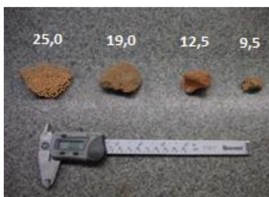
**Figura 36.** Medição do resíduo cerâmico utilizado como agregados utilizando o paquímetro.
