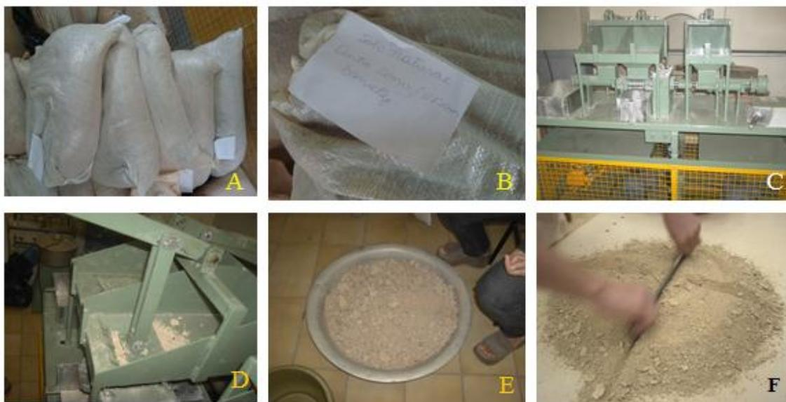
**Figura 11.** Etapas do beneficiamento e preparação das amostras de Solo Natural: A) Armazenamento após coleta; B) Amostras identificadas; C) Destorroadora/extrusora; D) Solo natural em processo de destorroamento mecânico; E) Solo destorroado e F) Quarteamento para separação das amostras parciais.
