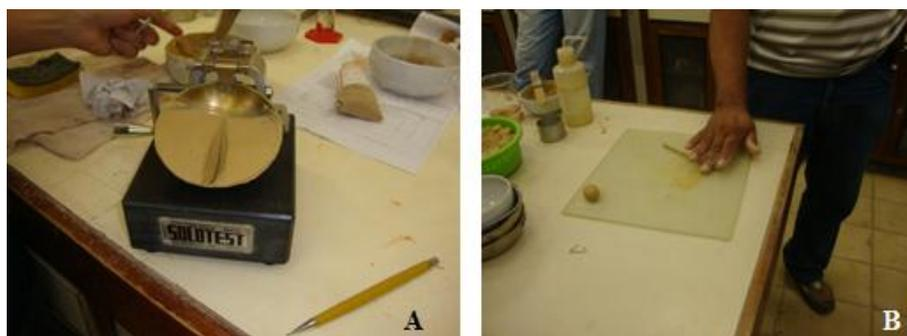
**Figura 15.** Ensaios de determinação dos limites de consistência: A) Aparelho de Casagrande para determinação do Limite de Liquidez e (B) Moldagem do cilindro de solo para determinação do Limite de Plasticidade.
