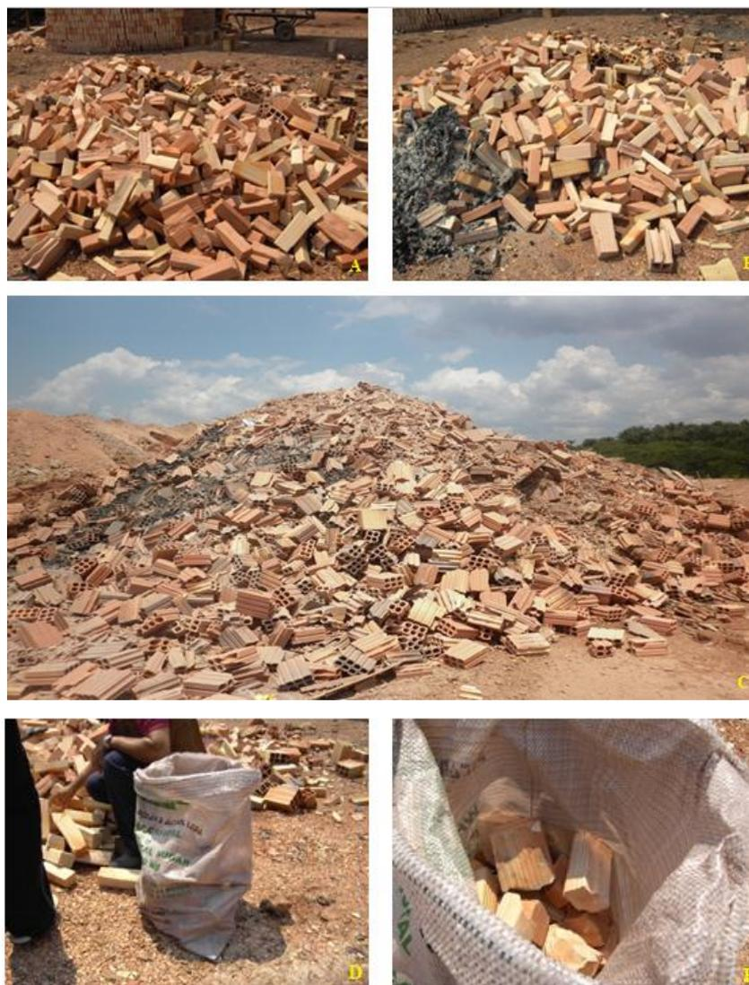
**Figura 22.** Resíduo Cerâmico. A) Pilha de resíduo cerâmico no pátio lateral esquerdo da Indústria Cerâmica Rio Negro LTDA; B) Pilha de resíduo cerâmico no pátio lateral direito da indústria; C) Pilha maior de resíduo cerâmico depositado nos fundos da indústria; D) Coleta de tijolos descartados e E) Armazenamento para posterior utilização na pesquisa
