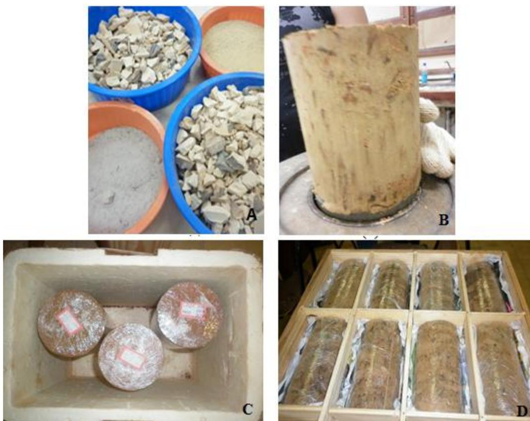
**Figura 40.** Etapas da Confeção dos corpos de prova da Mistura Solo Arenoso-Resíduo para envio a COPPE/UFRJ: A) Confeção das misturas; B) corpo de prova moldado; C) corpos de prova embalados com filme plástico e acondicionados em isopor para conservação da umidade ótima e D) corpos de prova embalados com filme plástico e com proteção ao deslocamento, acondicionados na caixa de madeira.
