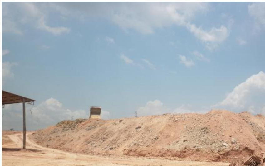
**Figura 24.** Argila extraída depositada no pátio da olaria, em processo de sanzonamento.
