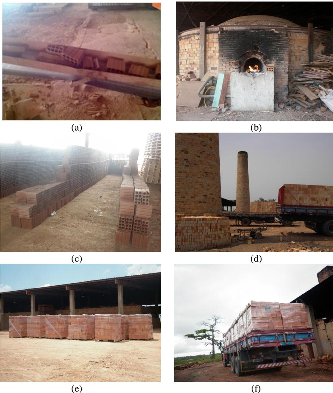
**Figura 28.** Processo Produtivo da Cerâmica Rio Negro LTDA: (a) Descarte de peças com ocorrência de má conformação; (b) Queima dos produtos em conformidade; (c) secagem natural das peças cerâmicas; (d) Chaminé oleira; (e) empacotamento das peças cerâmicas em pallets; (f) expedição dos tijolos cerâmicos para comercialização.
