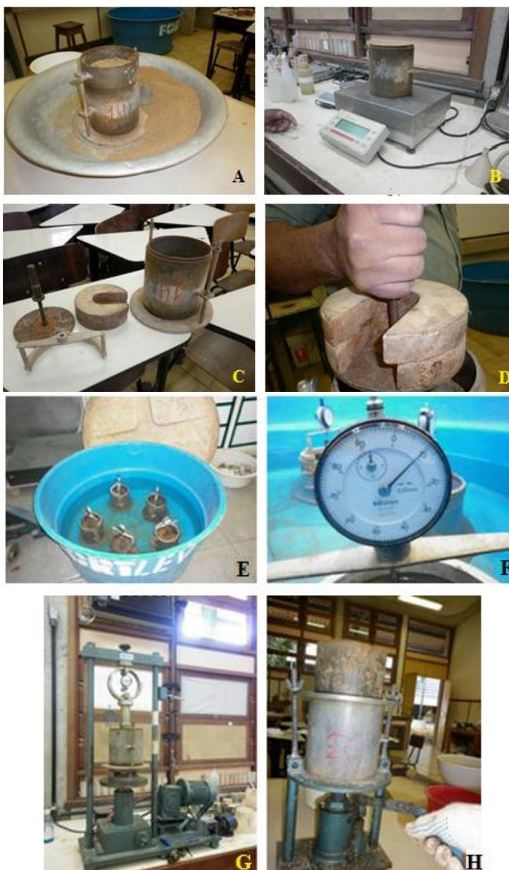
**Figura 18.** Etapas para determinação do Índice de Suporte Califórnia: A) compactação da amostra de solo de acordo com umidade ótima e grau de compactação pré-determinados; (B) pesagem do conjunto amostra + cilindro; (C) componentes utilizados para preparação do conjunto cilindro + amostra para imersão; (D) colocação das cargas para pressão durante a imersão; (E) imersão das amostras; (F) defletômetro indicando leitura da expansão; (G) prensa do ensaio de CBR e (H) extração da amostra.
