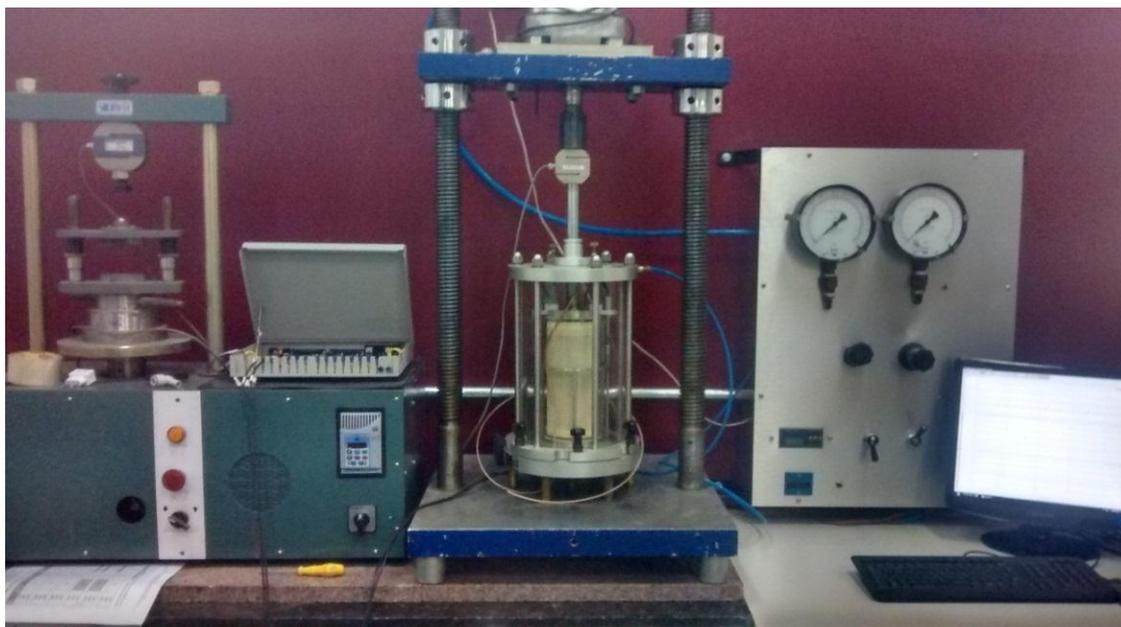
**Figura 48.** Equipamento da USP montado para realização do ensaio para determinação do Módulo de Resiliência e conectado ao microcomputador.
