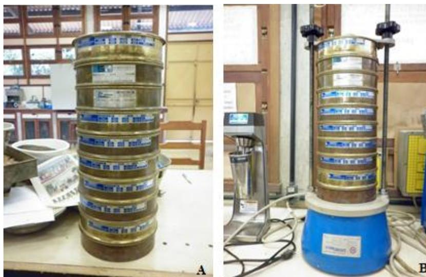
**Figura 39.** Granulometria das Misturas Solo Resíduo: A) peneiras utilizadas para o ensaio de análise granulométrica e B) agitador mecânico de peneiras.
