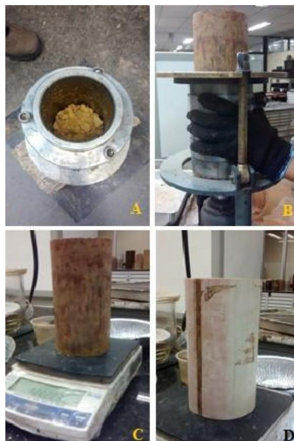
**Figura 45.** Confeção dos corpos de prova: A) Compactação e moldagem do CP ; B) extração do CP; C) pesagem do CP e D) colocação do molde de PVC para colocação na câmara úmida.
