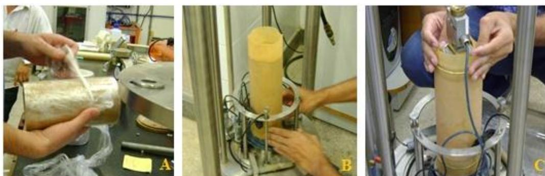
**Figura 41.** Sequência dos procedimentos de preparação do corpo de prova para o ensaio de Módulo de Resiliência: A) Retirada do filme plástico para colocação da membrana de látex; B) posicionamento em base porosa e C) colocação da membrana no cabeçote e base do aparelho.
