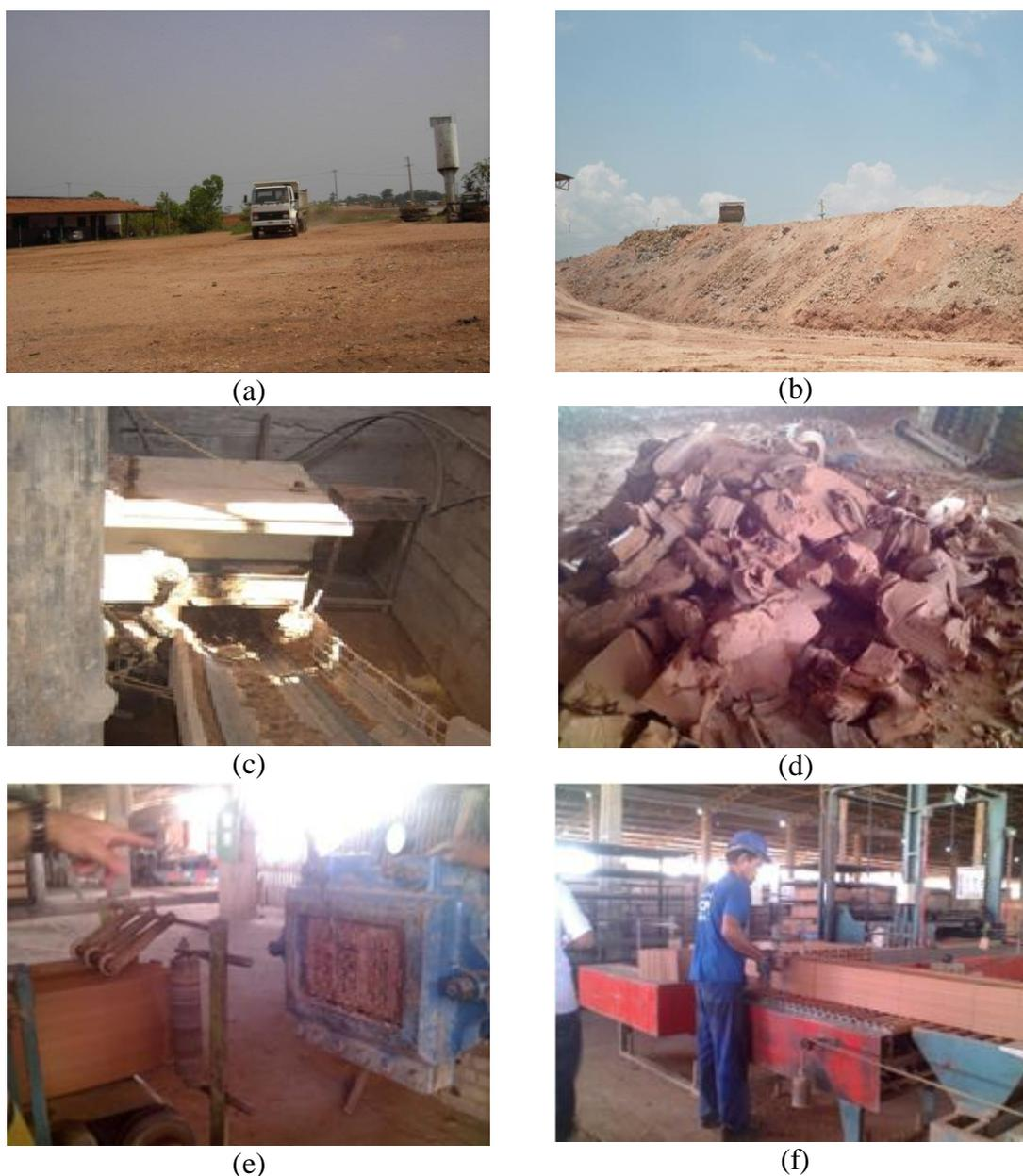
**Figura 26.** Processo Produtivo da Indústria Cerâmica Rio Negro LTDA: (a) Transporte da matéria-prima extraída das jazidas, em caminhão basculante (b) pilha de argila para sazonalização; (c) destorroadora; (d) preparação da massa cerâmica; (e) extrusão e conformação das peças cerâmicas; (f) inspeção para verificação de peças resultante de falha no processo, após a etapa de laminação.
