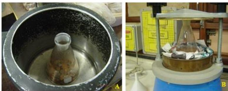
**Figura 34.** Etapas do ensaio de desgaste após fervura: A) fervura e B) agitação.
