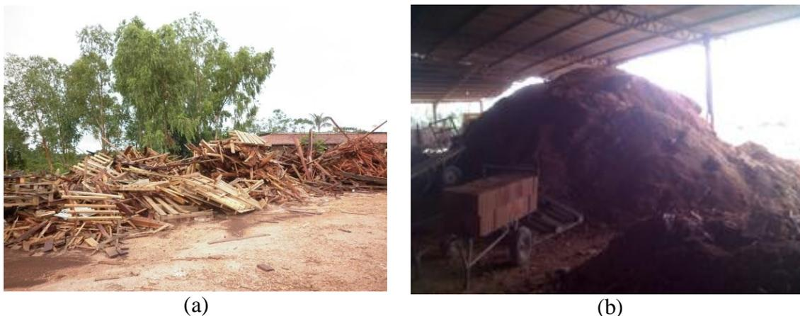
**Figura 30.** Materiais utilizados para a queima de peças cerâmicas na Indústria cerâmica Rio Negro: (a) pilha de madeira reciclada e (b) pilha de serragem utilizada como matriz energética para os fornos.
