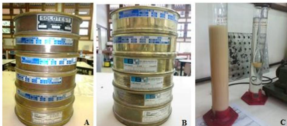
**Figura 12.** Análise Granulométrica: A) Peneiramento fino: Peneiras com abertura equivalente de 0,075 mm a 1,19 mm. B) Peneiramento grosso: Peneiras de Abertura equivalente de 2,00 mm a 50,8 mm. C) Ensaio de Sedimentação na fração mais fina de solo, com granulometria inferior a 0,075 mm.
