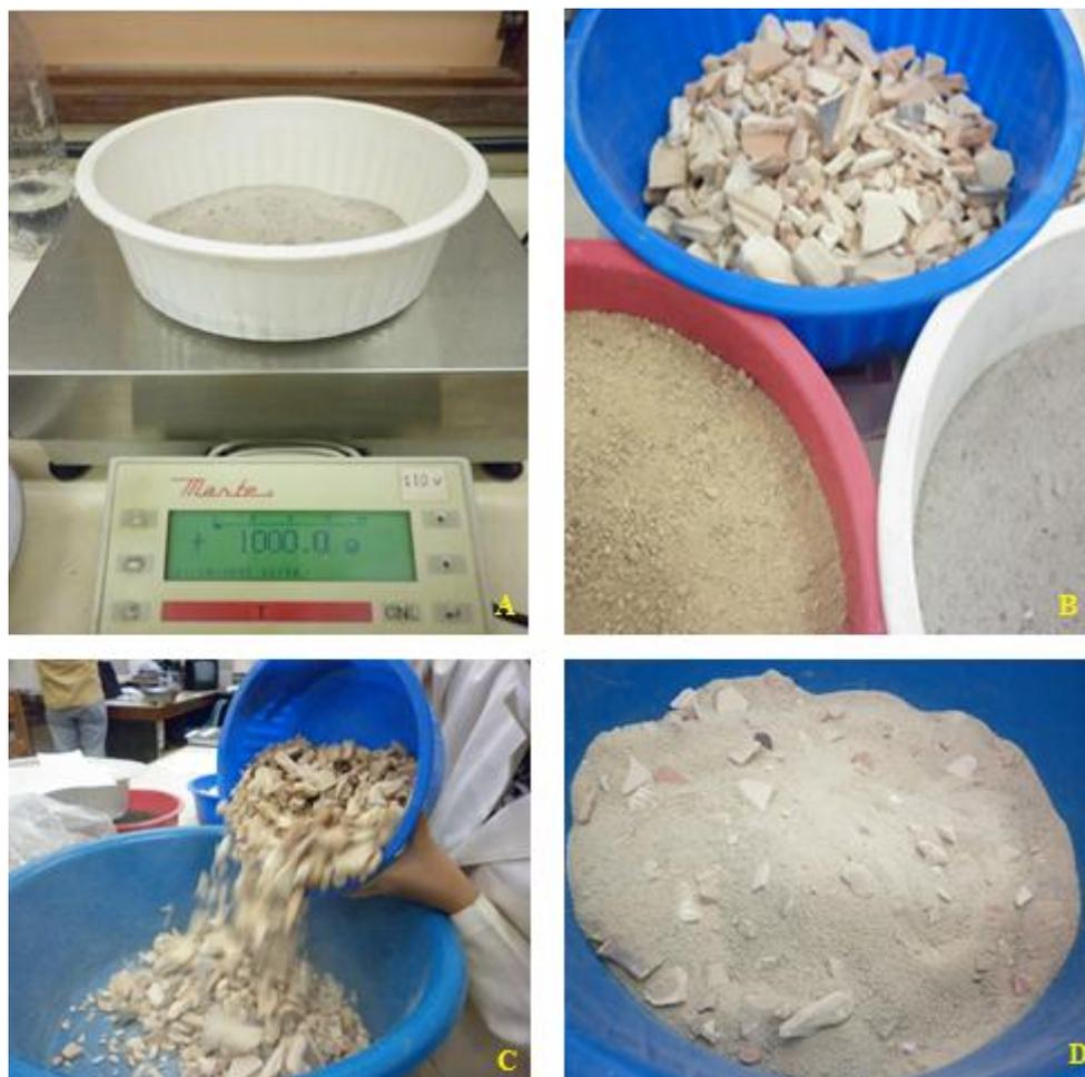
**Figura 38.** Etapas da dosagem das Misturas Solo Arenoso - Resíduo: A) Pesagem do agregado miúdo (areia); B) Frações pesadas de solo natural, areia e resíduo; C) mistura dos materiais e D) mistura finalizada na faixa pré-determinada.
