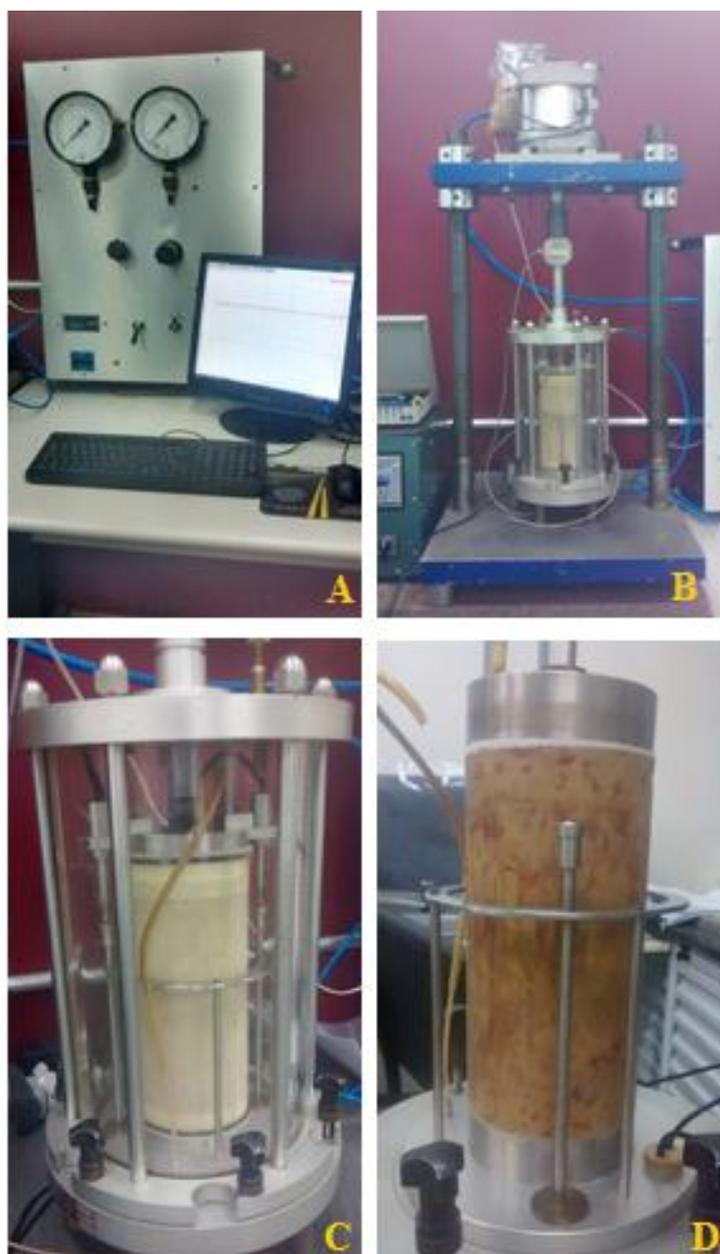
**Figura 47.** Ensaio para determinação do Módulo de Resiliência: A) Monitor para acompanhamento do ensaio; B) CP durante o ensaio triaxial dinâmico; C) ranhuras observadas na membrana de borracha durante o ensaio e D) finalização do ensaio triaxial dinâmico.
