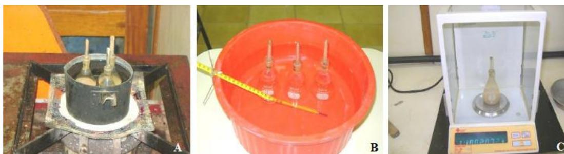
**Figura 16.** Sequência do ensaio de massa específica real do solo: A) Fervura dos picnômetros; B) Descanso em água em temperatura ambiente e medição de temperatura; e C) pesagem do picnômetro.
