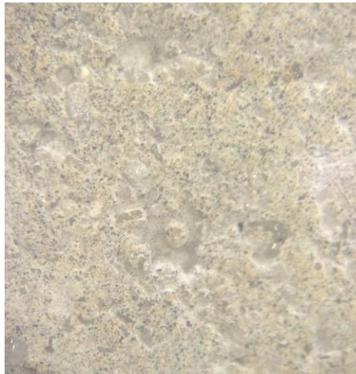
Figura 32 – Microscopia ótica do compósito sem PEBD (face interna) – ampliação 20x
