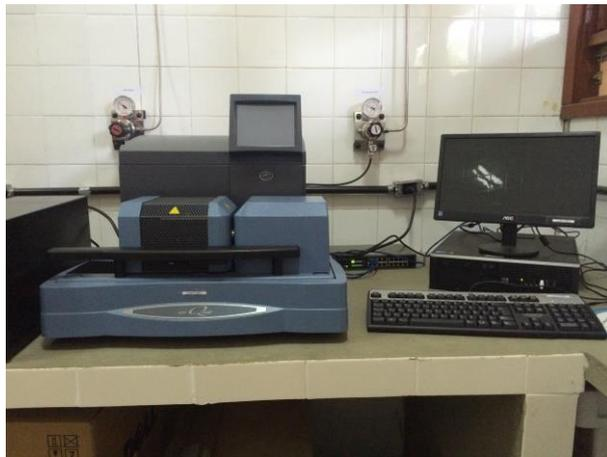
Figura 16 – Equipamento de termogravimetria
