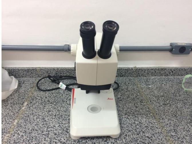
Figura 21 - Estereoscópio
