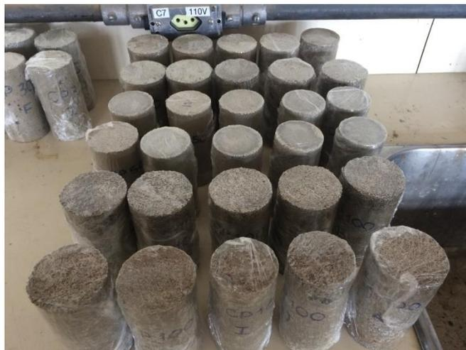
Figura 18 – Cura úmida dos corpos de prova
