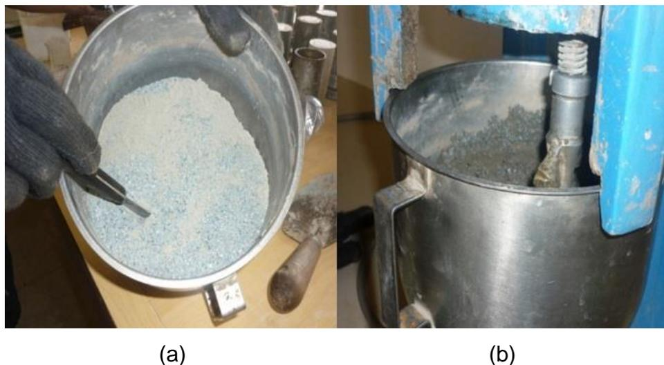
Figura 17 - Mistura do material seco e preparo da argamassa: (a) mistura do material seco e (b) preparo da argamassa
