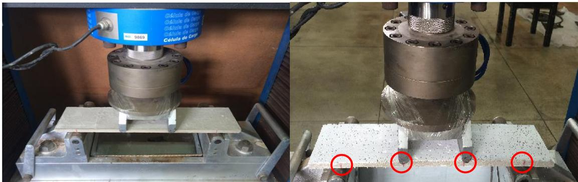
Figura 26 – Ensaio à flexão em quatro pontos
