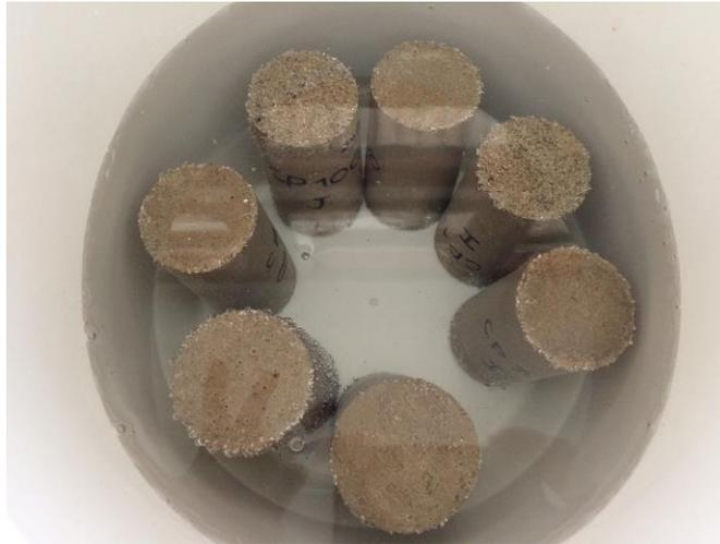
Figura 22 – Saturação dos corpos de prova
