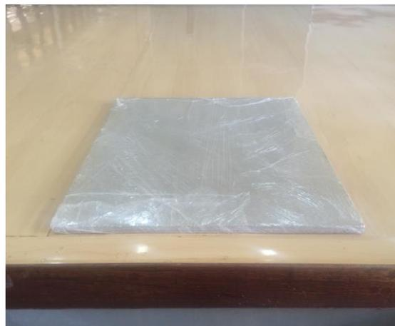
Figura 20 - Cura úmida da placa cimentícia
