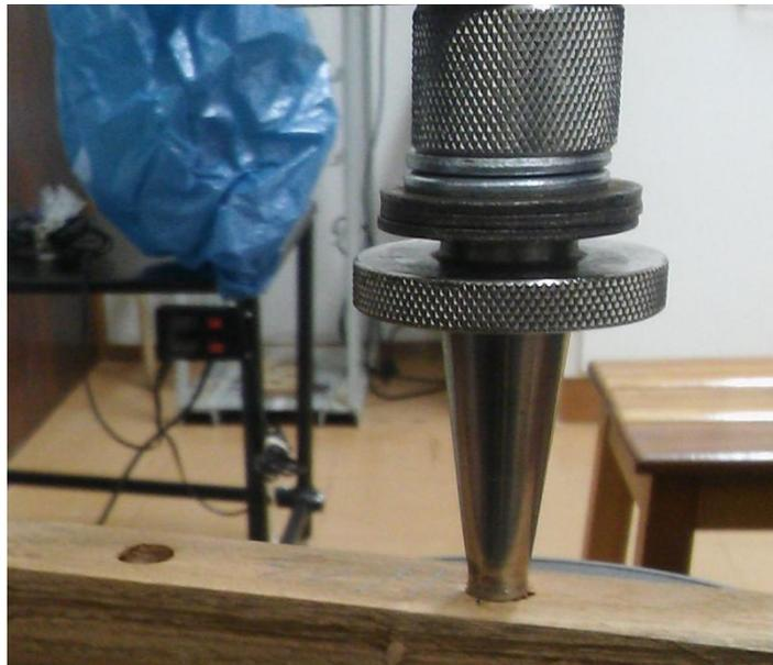
Figura 12. Ensaio de dureza Janka
