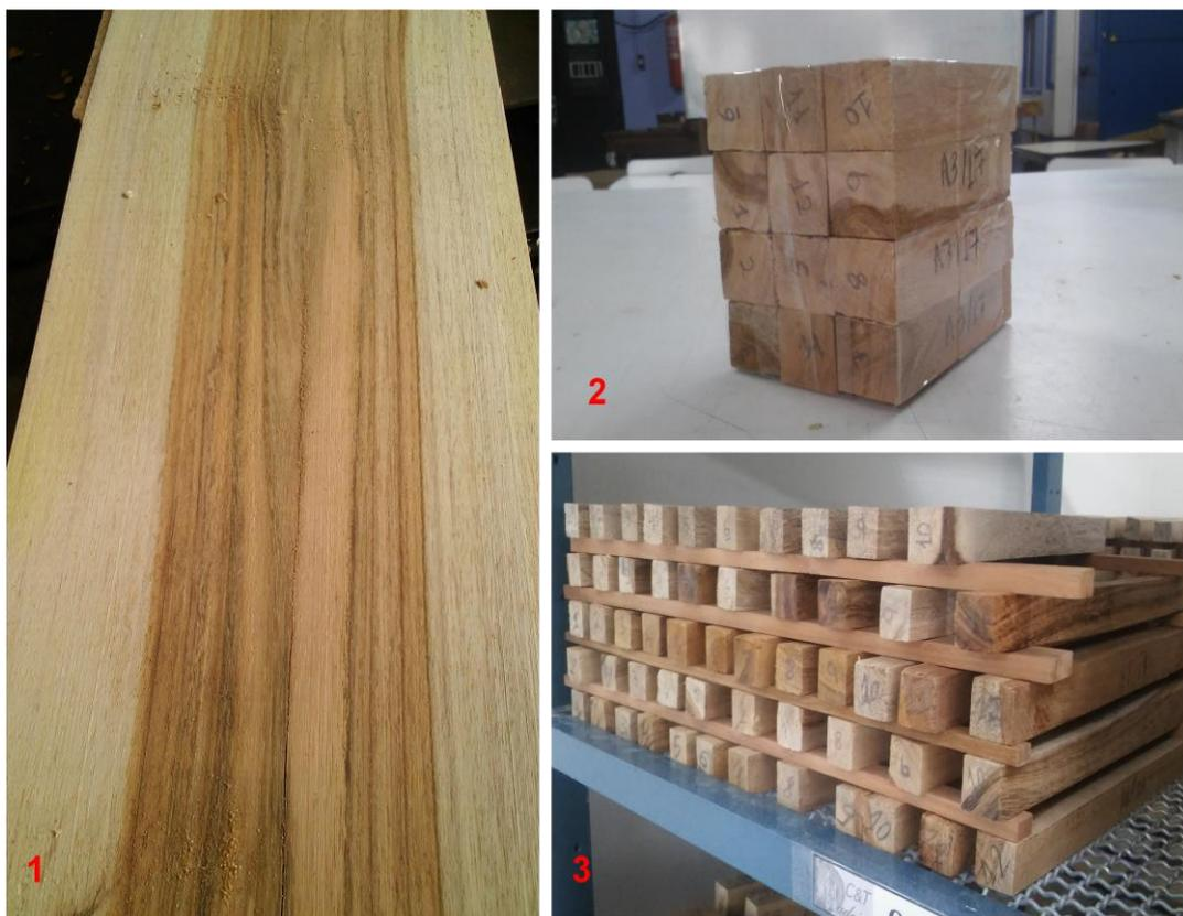
**Figura 9.** 1-Prancha beneficiada; 2-Lote de corpos de prova enviado para UFLA, acondicionamento em sala de climatização
