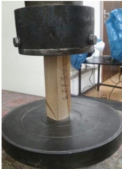
**Figura 10.** Ensaio de compressão paralela às fibras
