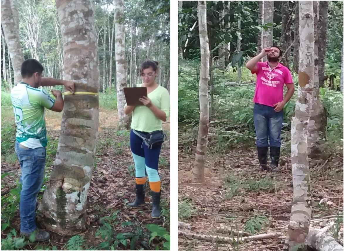
**Figura 3.** Mensuração do diâmetro à altura do peito e altura comercial das árvores
