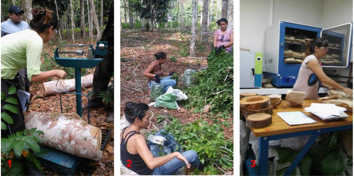
**Figura 7.** 1-Pesagem; 2-Amostragem de folhas e galhos; 3-Secagem das amostras em estufa
