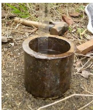
Figura 16: Infiltrômetro de *Hills*.
