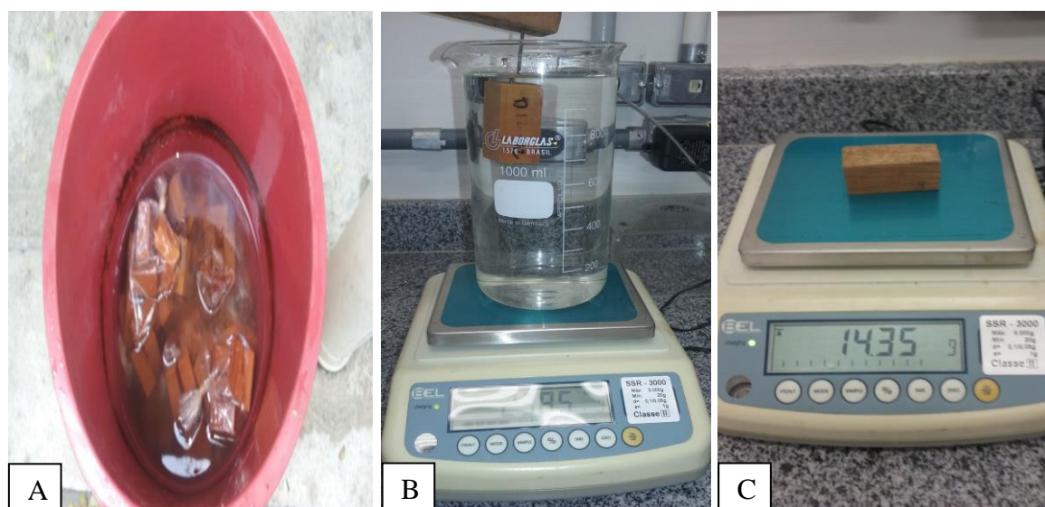
A-Saturação das amostras. B- Método do deslocamento de líquido do peso verde. C- Pesagem do peso seco. Fonte: Lira, J.N. 2015.
