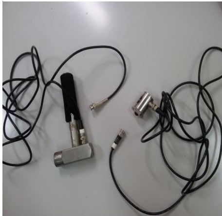
Figura 7 - Martelo e sensores.
