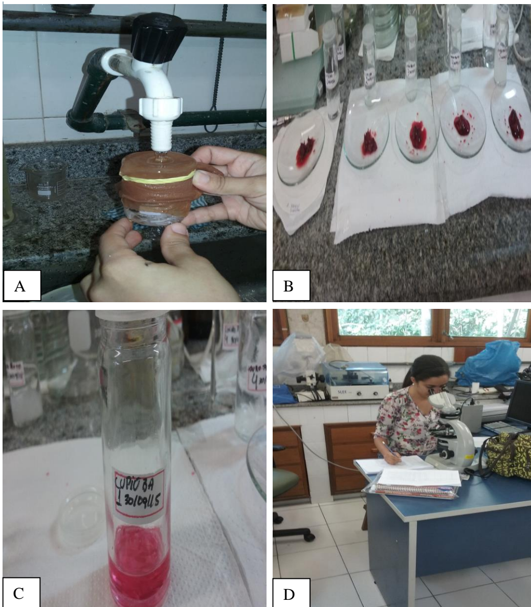
A- Lavagem do material em água corrente. B- Material sem corante em tubos e em corante em placa de vidro. C- Material com corante a ser colocado em lâmina para leitura anatômica. D- Leitura do elementos anatômicos no microscópio estereoscópio.
