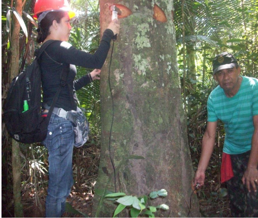
Figura 11 - leitura da propagação de onda em árvore em pé no sentido diagonal.
