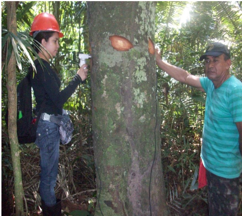
Figura 12 - leitura da propagação de onda em árvore em pé no sentido transversal.
