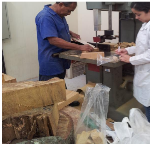
Figura 17 - Corte do discos em cunhas e corpos-de-prova.
