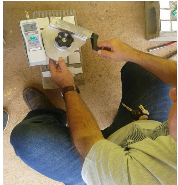
Figura 3.11 – Marcador digital mostrando o valor de arrancamento durante o ensaio.
