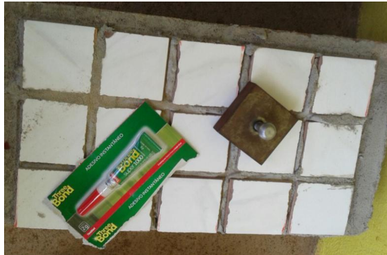
Figura 3.8 – Detalhe das placas cerâmicas assentadas antes do ensaio, da pastilha metálica e da cola instantânea utilizada no procedimento de arrancamento.
