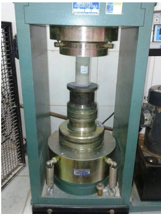
Figura 3.12 – Detalhe do ensaio de compressão axial.
