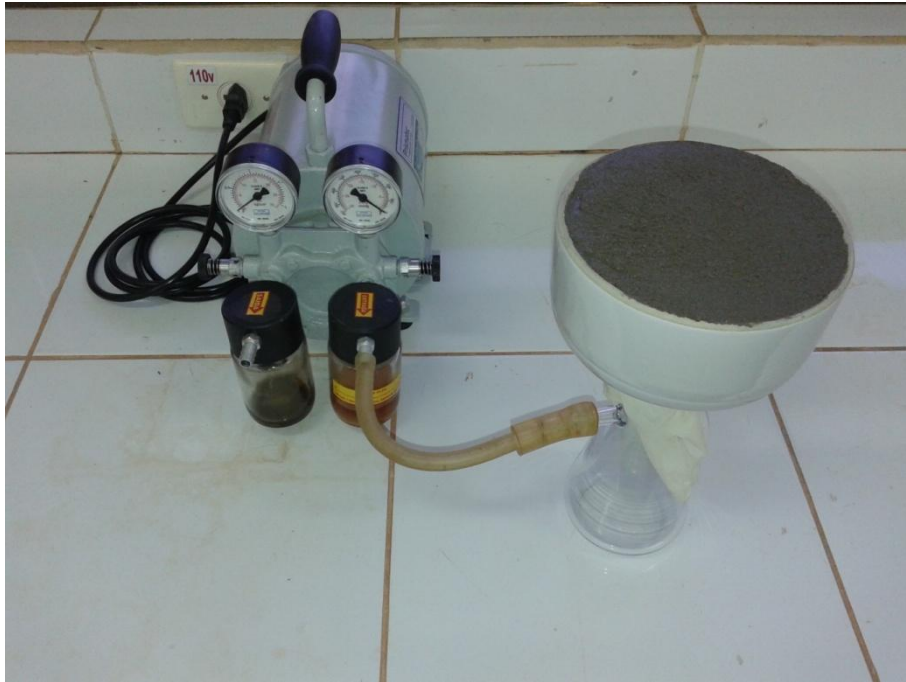
Figura 3.5 –Funil de Büchner adaptado para o ensaio de retenção de água
