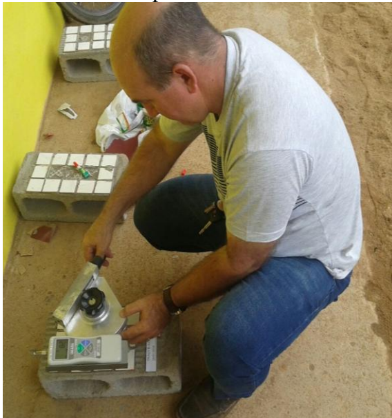
Figura 3.10 – Realização do ensaio de arrancamento da placa cerâmica.
