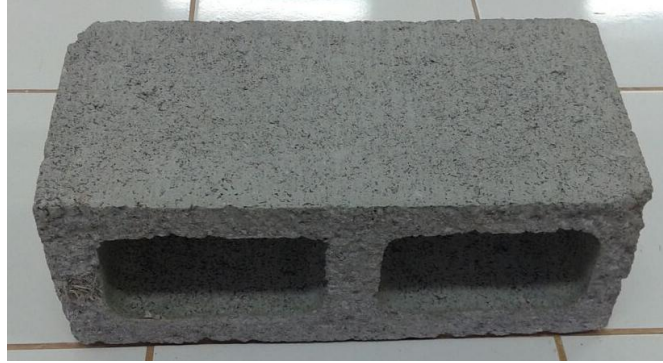
Figura 3.6 – Bloco de concreto de dimensões 14x19x39cm utilizado como substrato padrão para assentamento das placas cerâmicas.
