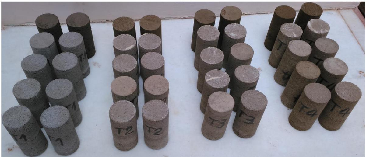
Figura 6. Corpos de prova preparados para ensaio de resistência à compressão.
