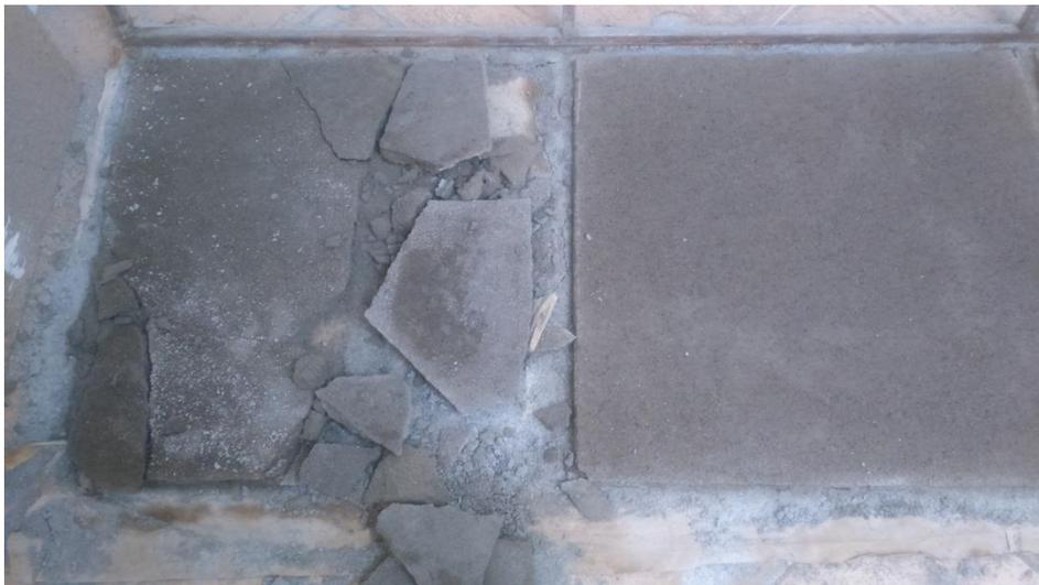
Figura 10. Painéis produzidos sem adição da metacaulinita e  $\text{Ca}(\text{OH})_2$ : sem ganho de resistência até 3 dias.
