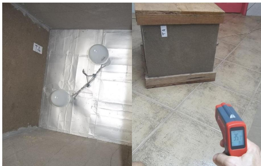
Figura 5. Montagem das lâmpadas (esq.) e medição da temperatura externa (dir.).
