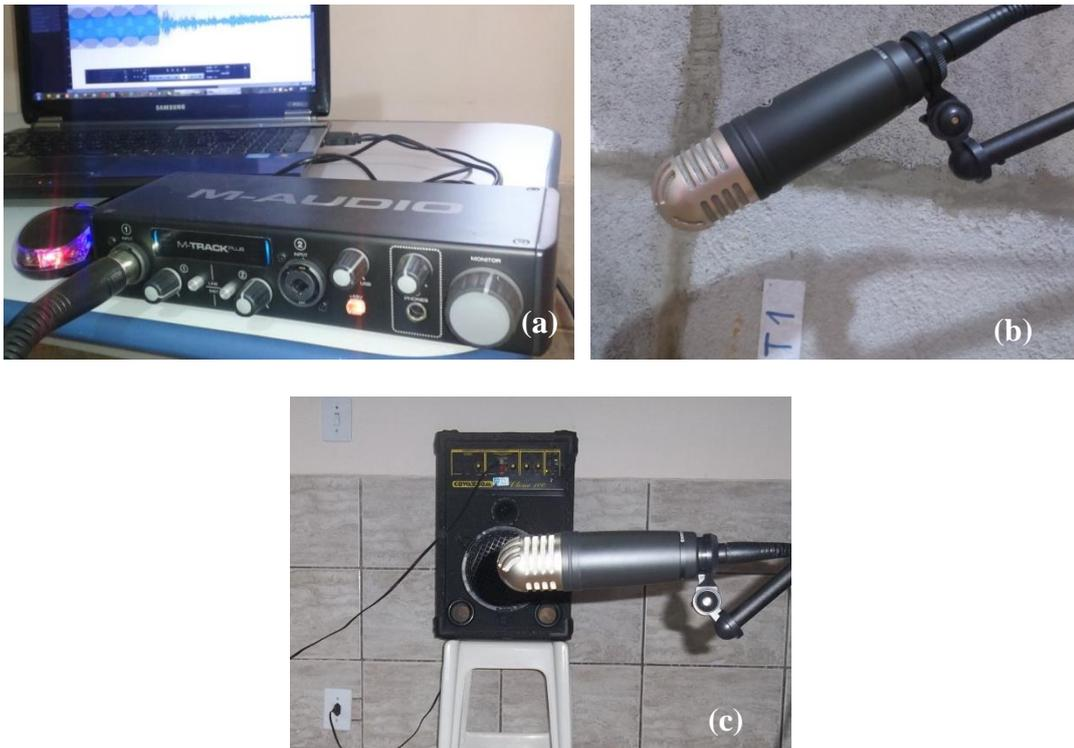
Figura 6. Interface analógico/digital (a) e microfone, utilizados nos ensaios de reflexão  $W_r$  (b) e incidência direta de campo-livre  $W_i$  (c).
