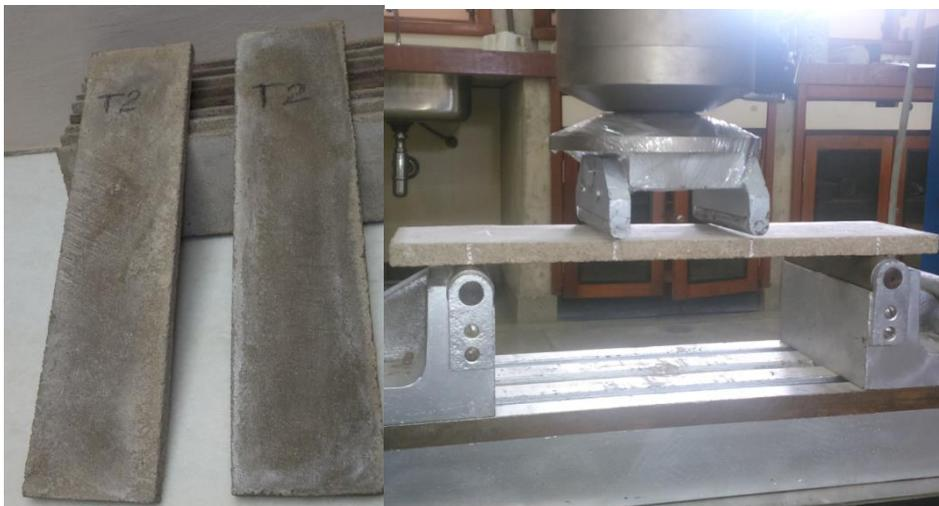
Figura 7. Corpos de prova para ensaio de resistência à tração na flexão (Esq.) e preparação do dispositivo para ensaio (Dir.).
