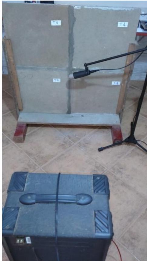
Figura 5. Configuração após montagem dos painéis, microfone e fonte.
