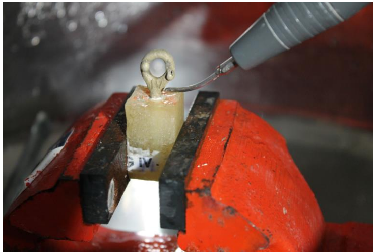
Figura 4: Aplicação da vibração ultrassônica.
