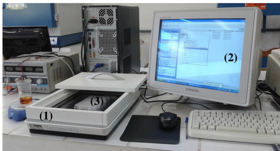
Figura 3 – Sistema de captura de imagens digitais. (1) scanner, (2) computador e (3) microplaca de 96 poços.
