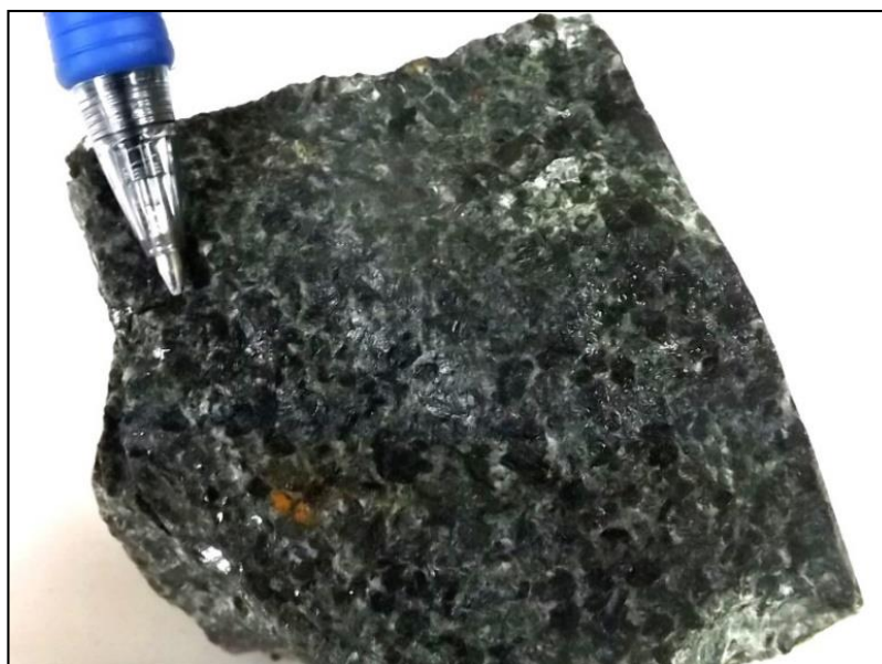
Figura 17: Amostra de gabronorito porfírico, com destaque para os fenocristais de enstatita e para o tom esverdeado da rocha, intrusão E (TF-10).
