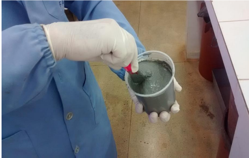
Figura 8 - Amassamento e homogeneização da argamassa
