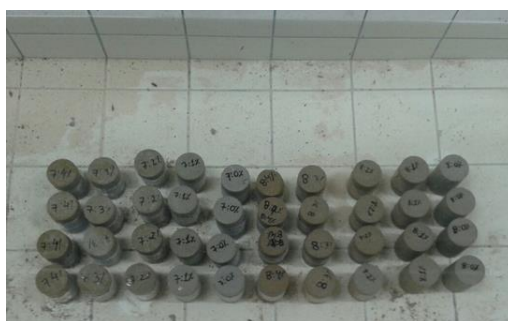
Figura 4-10 Corpos de prova imersos no tanque com água, durante a cura
