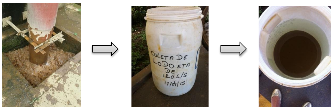
Figura 4-3 Coleta do lodo da ETA
