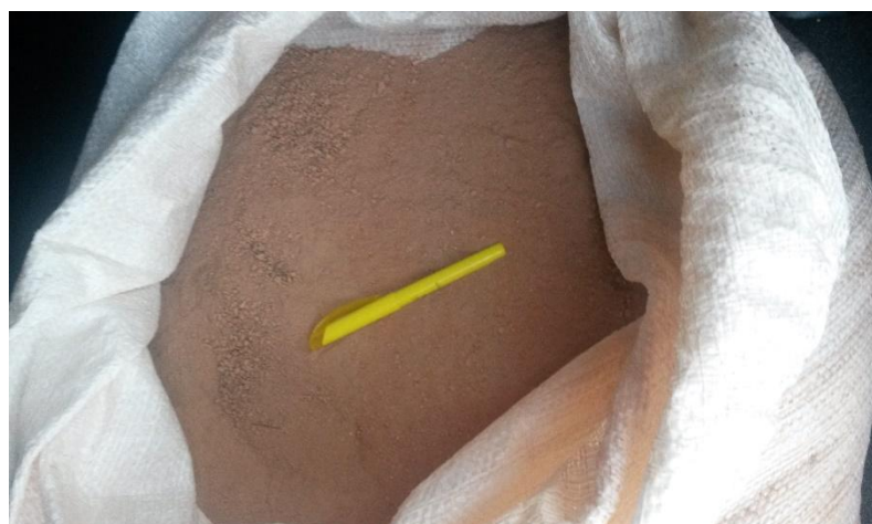
Figura 4 - Agregado miúdo reciclado obtido por moagem de RCD
