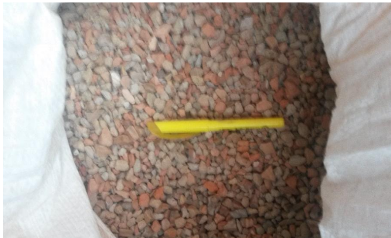
Figura 5 - Agregado graúdo reciclado obtido por moagem de RCD
