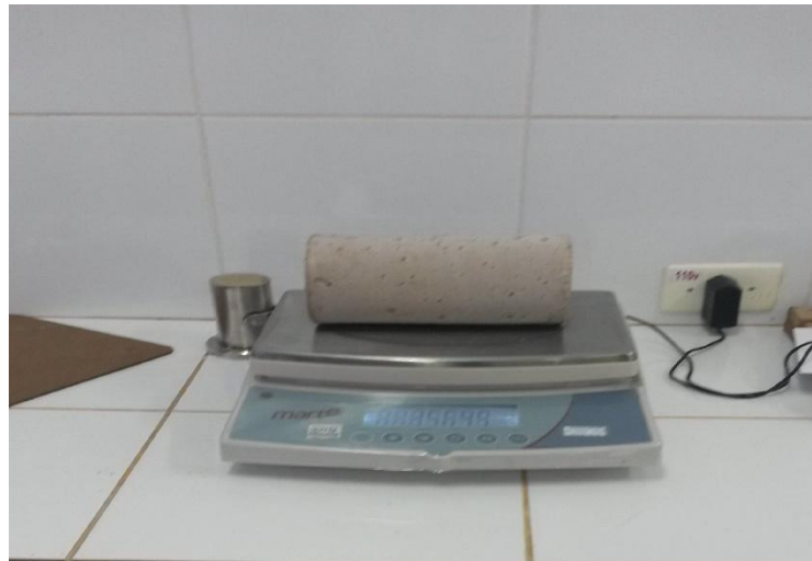
Figura 17- Pesagem do corpo úmido
