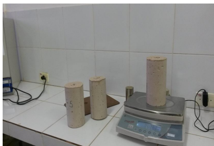
Figura 13 - Pesagem dos corpos de prova
