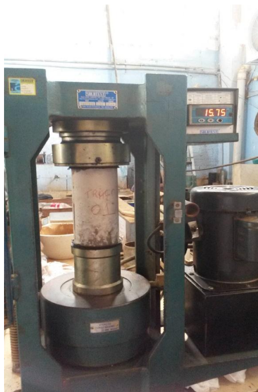
Figura 8 - Prensa utilizada no ensaio de resistência à compressão
