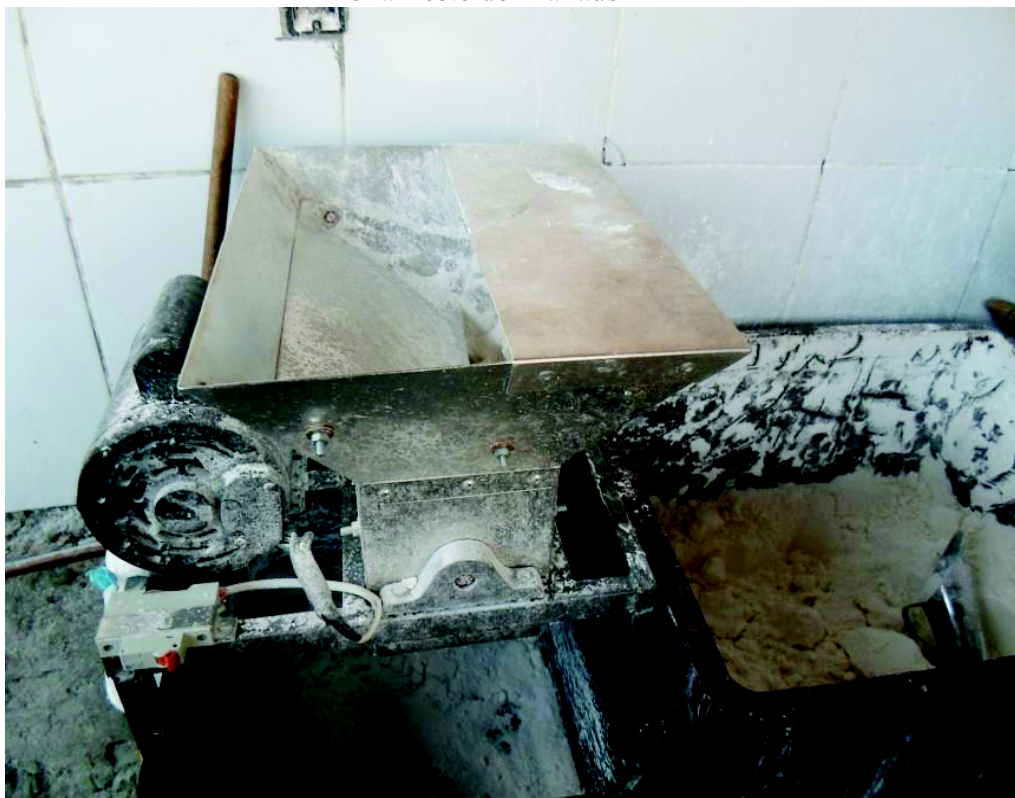
Figura 15: Máquina de peneirar fécula reidratada encontrada na Feira do Produtor, Zona Leste de Manaus – AM
