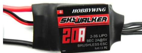
Figura 18- Controlador de velocidade
