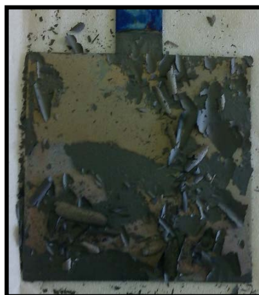
Figura 17 – Eletrodo de \text{Ti}/\text{Cu}_2\text{O} após tratamento térmico à 450^\circ\text{C} por 30 min.
