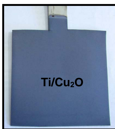
Figura 20 – Placa de \text{Ti}/\text{Cu}_2\text{O} após eletrodeposição em pH 12,0 e -0,4\text{V} .
