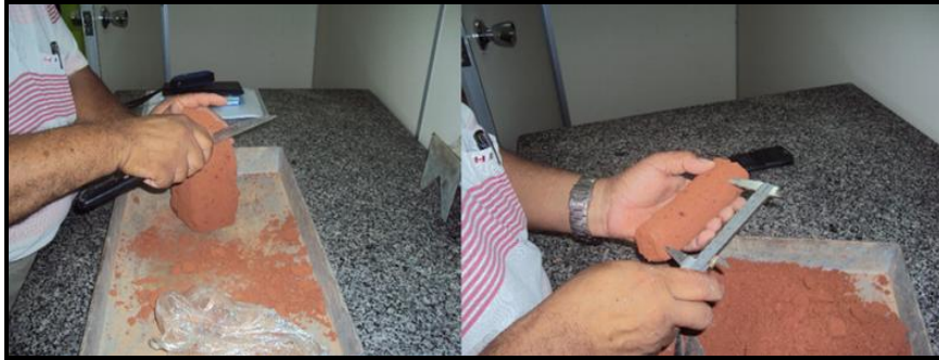
Figura 38 - Preparação do corpo de prova tomando as medidas normatizadas.
