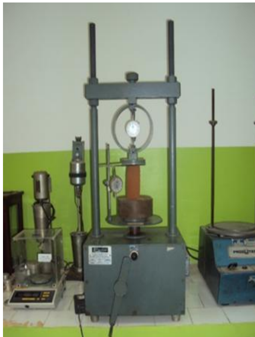
Figura 39 - Ensaio de compressão simples.
