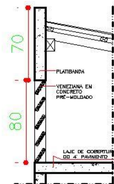
Figura 49 - Corte da Planta da Cobertura.
