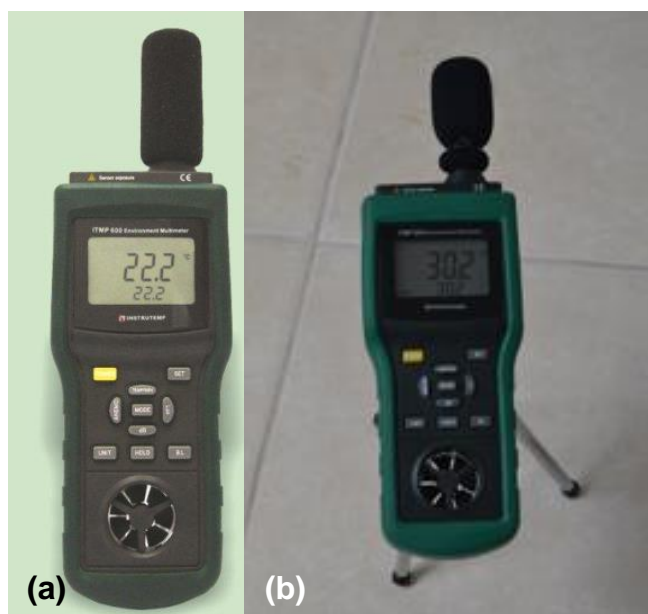
Figura 35 - (a) Medidor multifuncional ITMP-600, (b) com aparelho instalado para medições - Fonte: Empresa NR 2 Engenharia, 2015.
