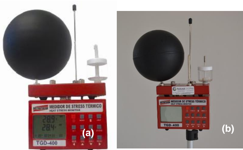
Figura 36 - (a) Medidor de Stress Térmico – TGD/ 400. (b) O Aparelho instalado para medições – Fonte: MR2 Engenharia.
