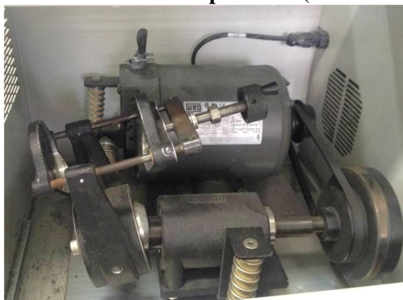
Figura 3.2-Moinho vibratório tipo SPEX (do LabMat).
