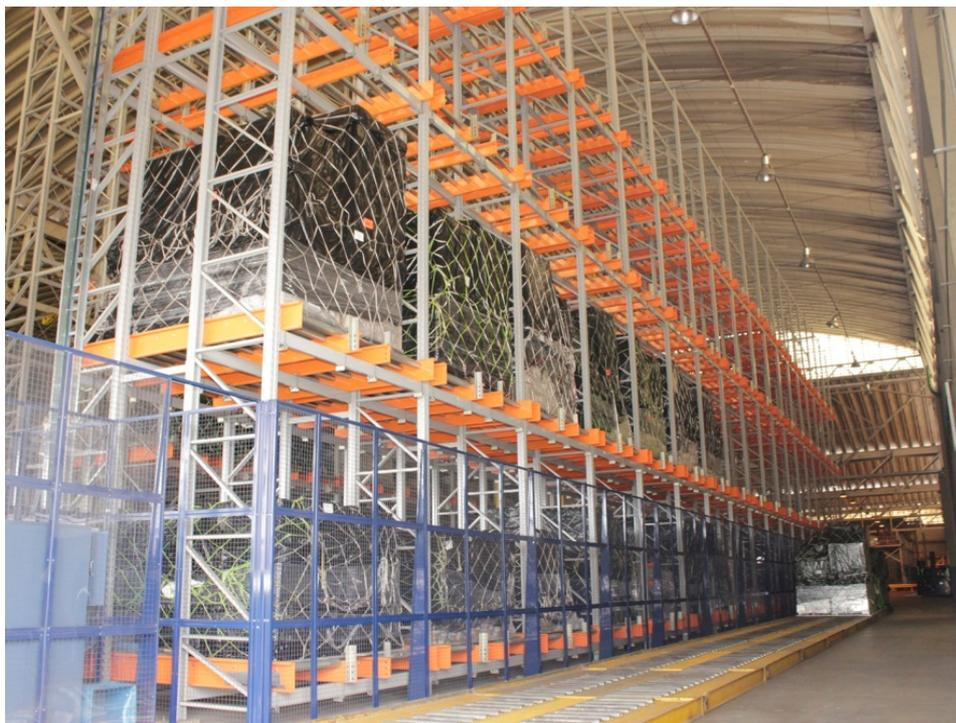
Figura 7: Armazenagem de carga, com sistema automatizado
