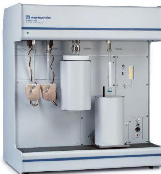
Figura 32 – Analisador de área superficial BET utilizado
