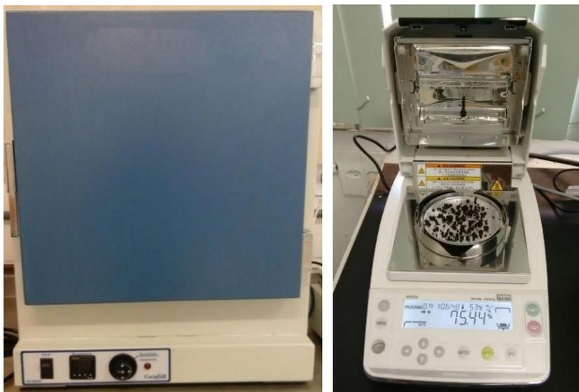
Figuras 11 e 12 – Estufa e analisador de umidade, respectivamente.
