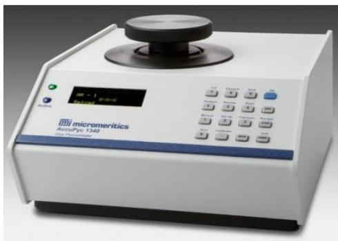
Figura 31 – Picnômetro utilizado
