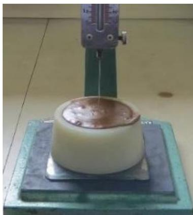
Figura 44 – Ensaio de determinação do tempo de pega da argamassa do Rio 1.
