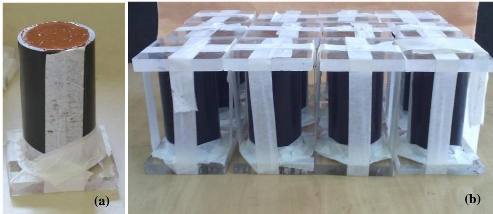
Figura 25 – Aspecto dos moldes: (a) após a rasadura e (b) fechados.
