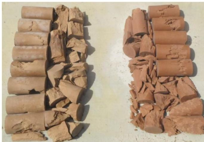
Figura 48 – Aspecto das argamassas após ciclos de molhagem e secagem natural.
