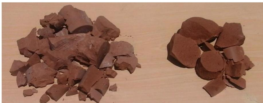
Figura 20 – Morfologia das pastas geopoliméricas iniciais. À esquerda, material produzido com adição de cálcio, à direita material sem adição de cálcio, isento de eflorescência.
