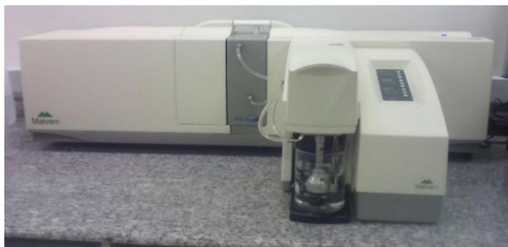
Figura 30 – Granulômetro utilizado
