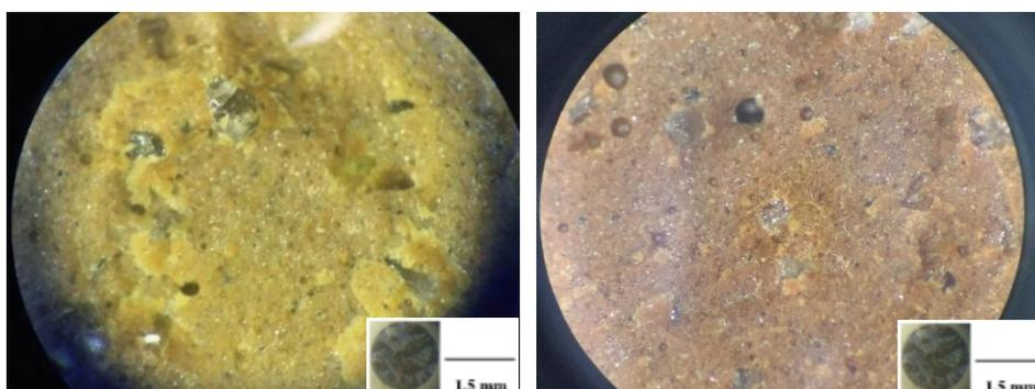
Figura 50 – Imagens de estereomicroscópio das superfícies fraturadas das argamassas.
