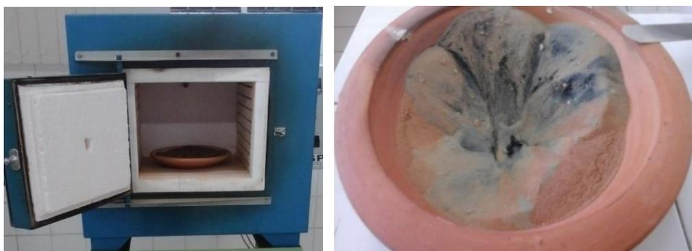
Figuras 17 e 18 – Forno mufla utilizado e aspecto do material após a calcinação realizada em um recipiente inadequado, respectivamente.
