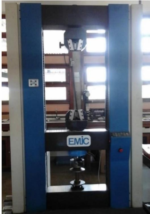
Figura 37 – Prensa de ensaios mecânicos utilizada
