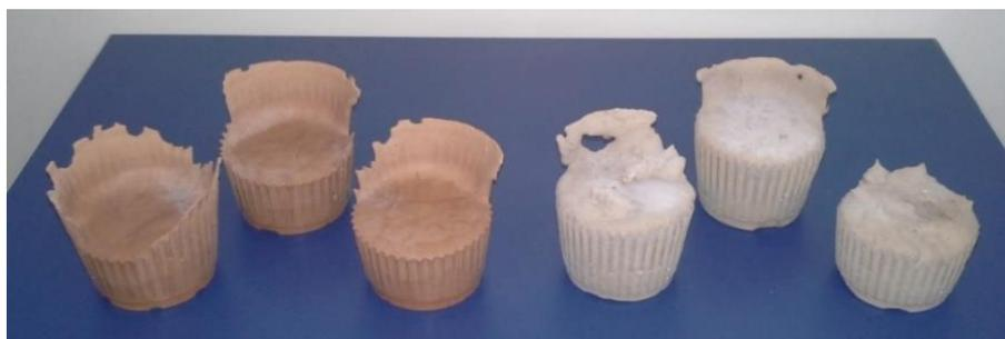
Figura 49 – Amostras submersas em água durante 27 dias.
