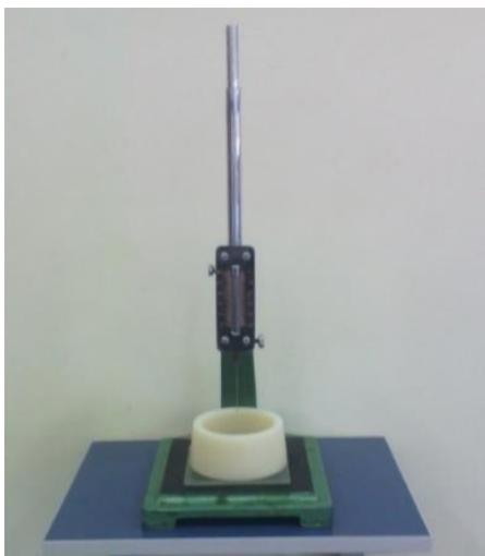
Figura 36 – Aparelho de Vicat utilizado
