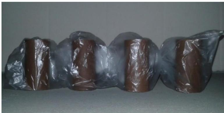
Figura 27 – Cura dos corpos de prova em sacos plásticos
