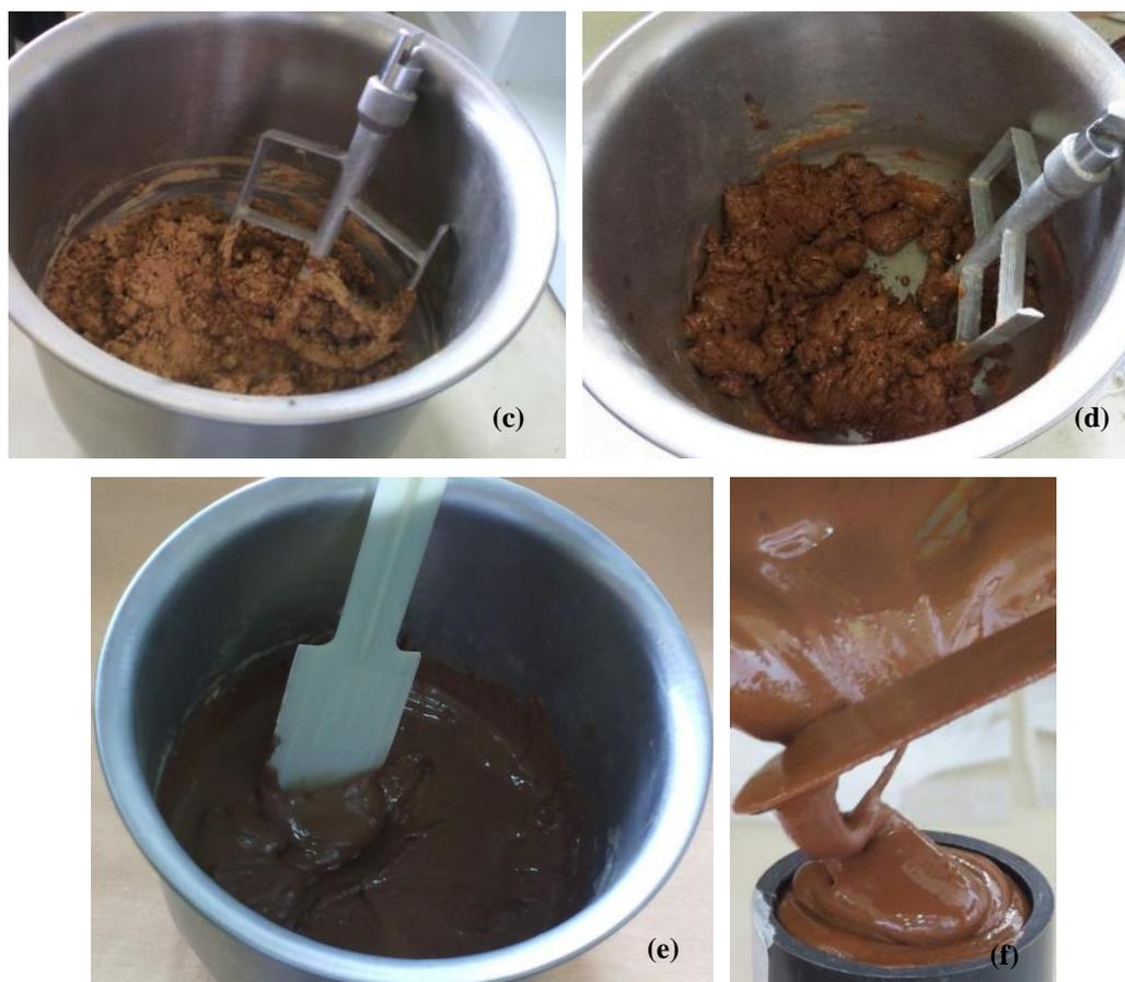
Figura 24 – Procedimento de mistura das argamassas geopoliméricas: (a) mistura dos componentes secos; (b) silicato de potássio sendo vertido na cuba do misturador; (c) aspecto do material após a primeira mistura dos componentes; (d) aspecto do material após a segunda mistura dos componentes; (e) aspecto da argamassa no final do processo de mistura; e (f) aspecto viscoso da argamassa fresca.
