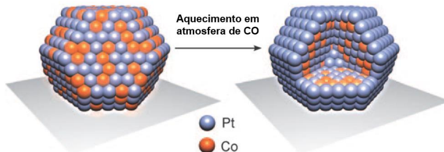
Figura 11 – Método de obtenção de estrutura core-shell descrito por Mayrhofer et al. (2009), a partir de uma liga de Pt-Co.
