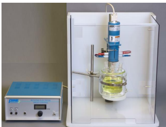
Figura 15 – Equipamento utilizado para medições de eletrodo de disco rotatório. Modelo: AFMSRCE; fabricante: Pine Research Instrumentation .
