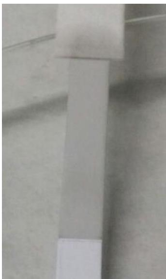
**Figura 11** : Fluxo do NTC filtrado – teste de fluxo do NTC depois da filtração, ausência de retenção na porção inferior da fita.
